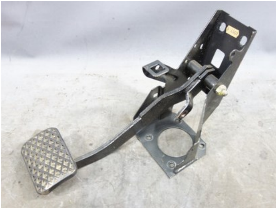
Slika 53: Izvedba pedale kočnice za cestovne automobile
