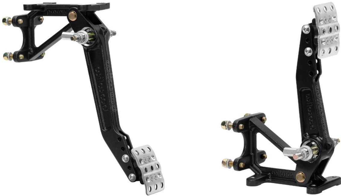
Slika 52: Izvedbe pedala kočnice kod vozila za utrke
