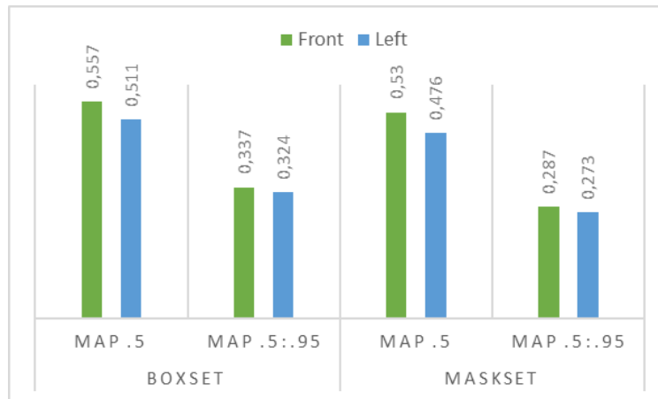
Slika 22: Usporedba performansi osnovnih perspektiva na rezultatima vozila modela Mask R-CNN.
