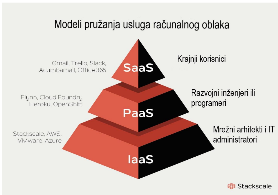
Slika 1. Modeli pružanja usluga računalnog oblaka, te njegovi korisnici s obzirom na njihove potrebe
