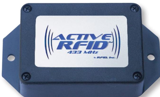
Slika 2 - Aktivna RFID oznaka (Izvor: https://www.rfidinc.com/uhf-433-mhz-active-rfid-tags )
