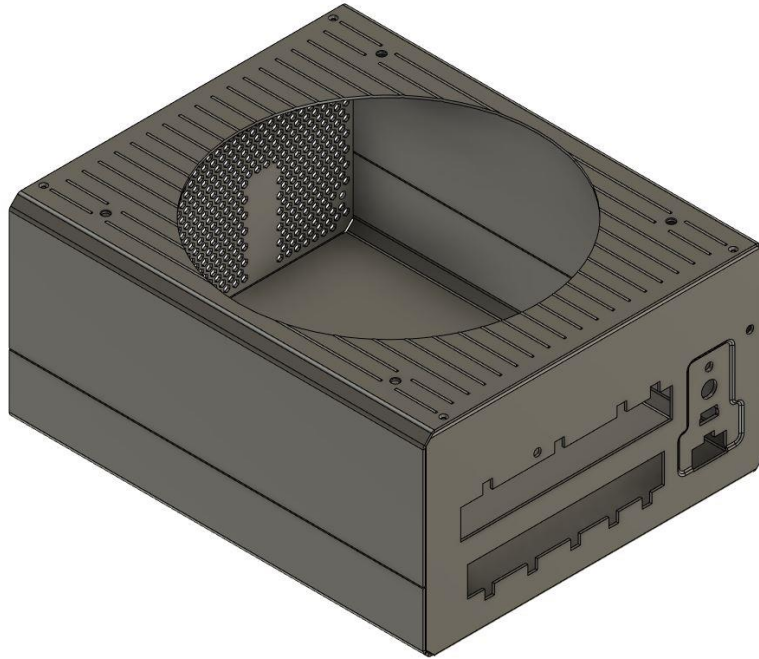
Slika 57 Pogled gotovog kućišta odiza/gore/desno
