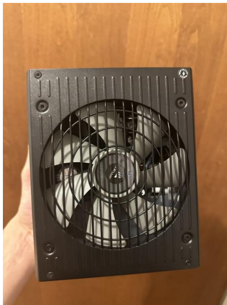
Slika 34 Prikaz gornjeg dijela napajanja – Izvor: Autor
