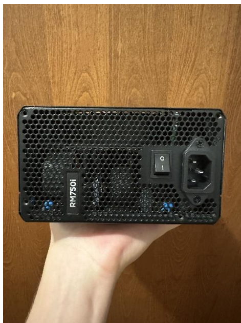
Slika 32 Prikaz prednjeg dijela napajanja – Izvor: Autor
