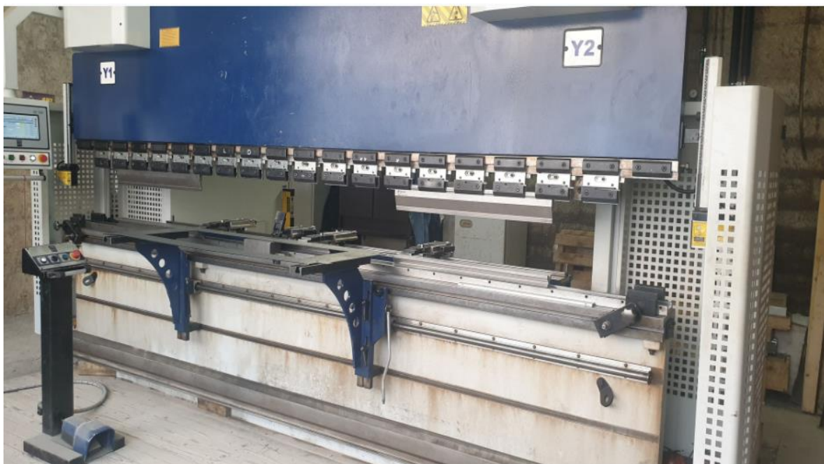
Slika 25 Savijačica od 320 tona snage savijanja
