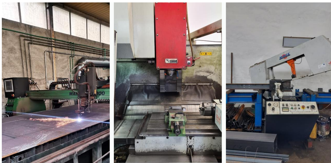
Slika 69 S lijeva na desno – CNC plazma, glodalica i pila
