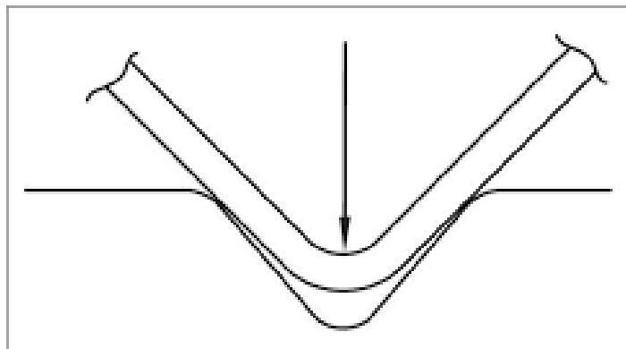
*Slika 6. Zračno savijanje sa tri točke - Izvor: ("Alat za savijanje metala", [www.legadorasandicizallas.net](http://www.legadorasandicizallas.net), 2019.)*
