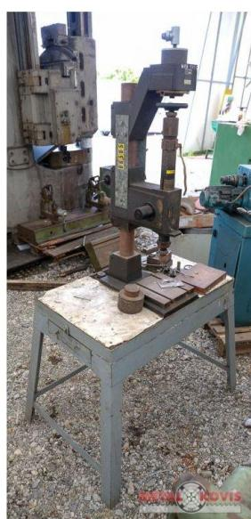
Slika 7. Stolna zračna preša - Izvor: ("www.metal-kovis.hr, 2023.)
