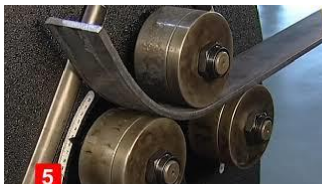
Slika 29: Stroj za savijanje profila s 3 cilindra
