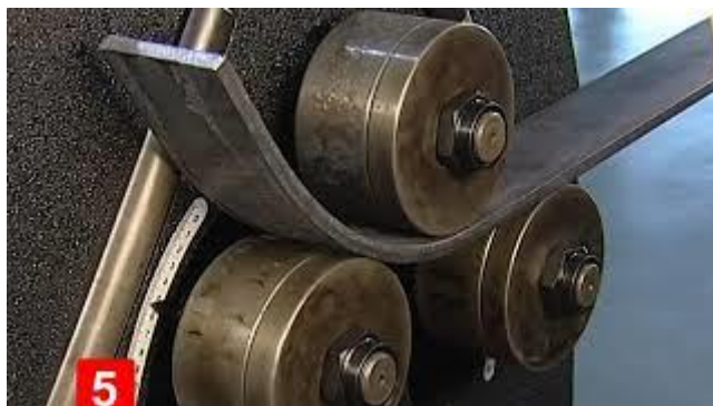
Slika 29: Stroj za savijanje profila s 3 cilindra
