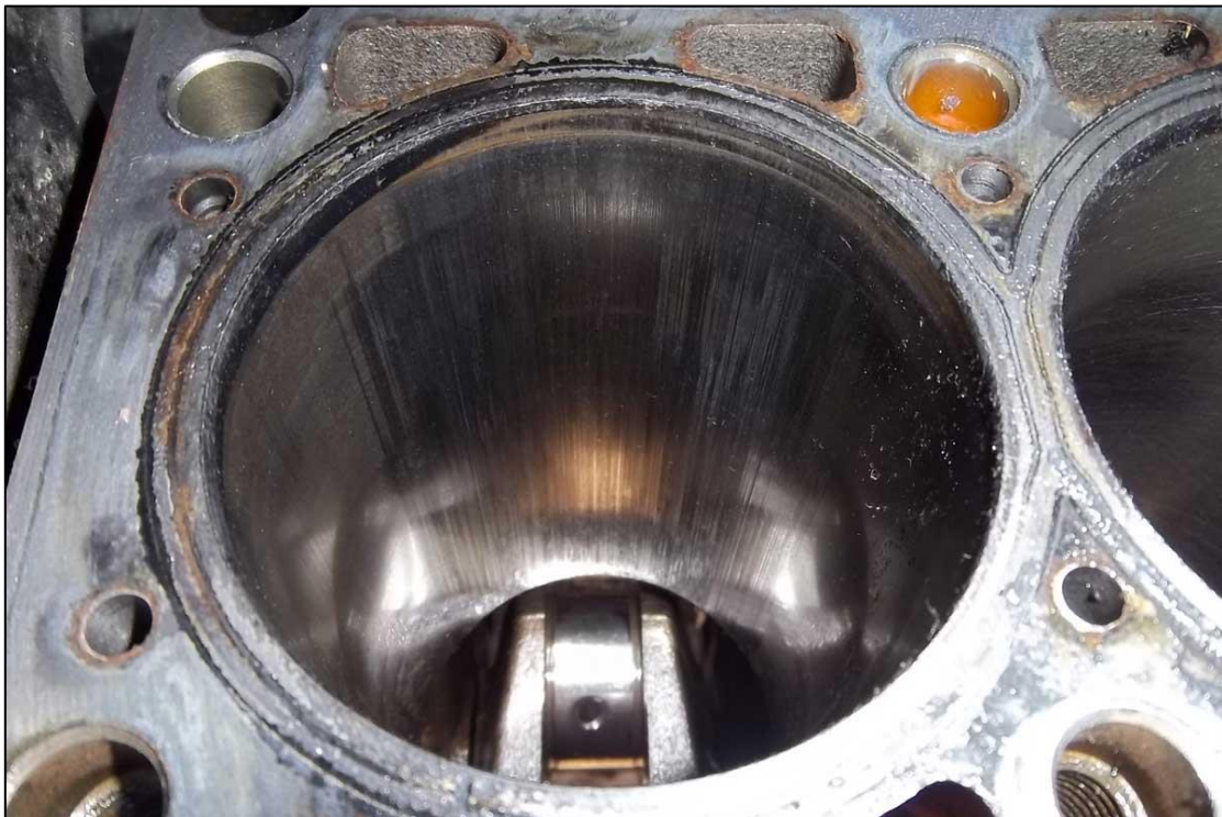
Slika 7. Vizualna inspekcija stanja cilindra
