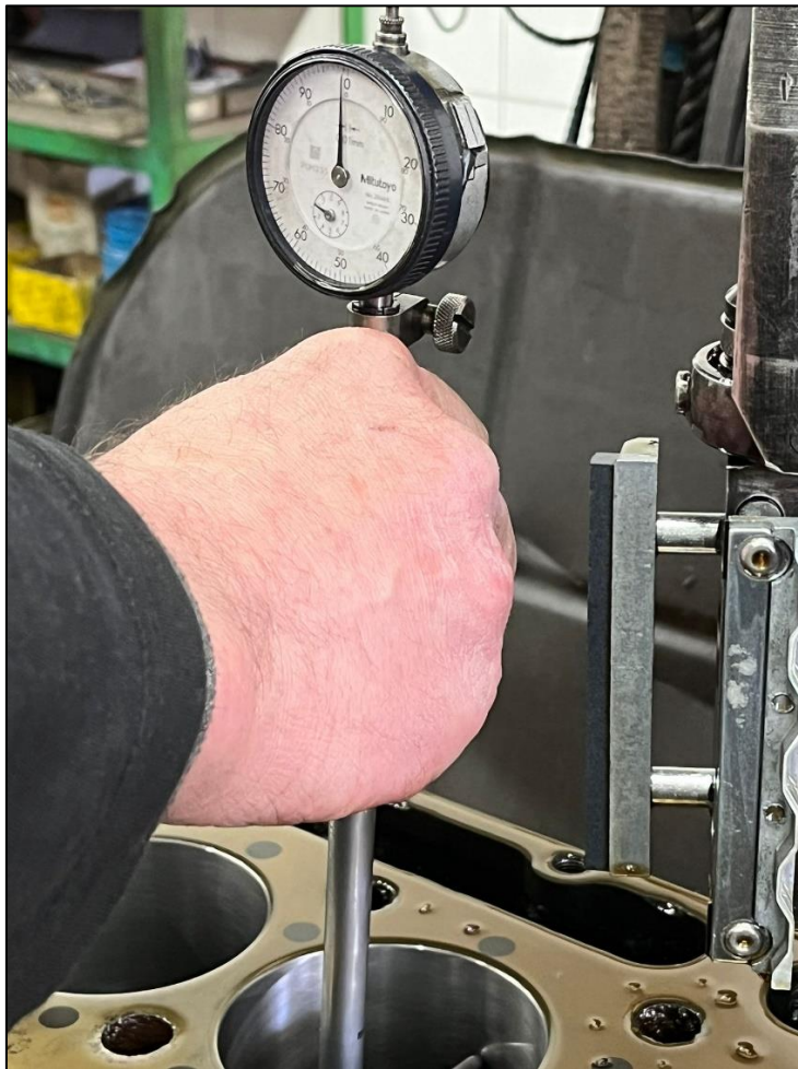
Slika 33. Mjerenje finalne obrade štapnom mjernom urom.
