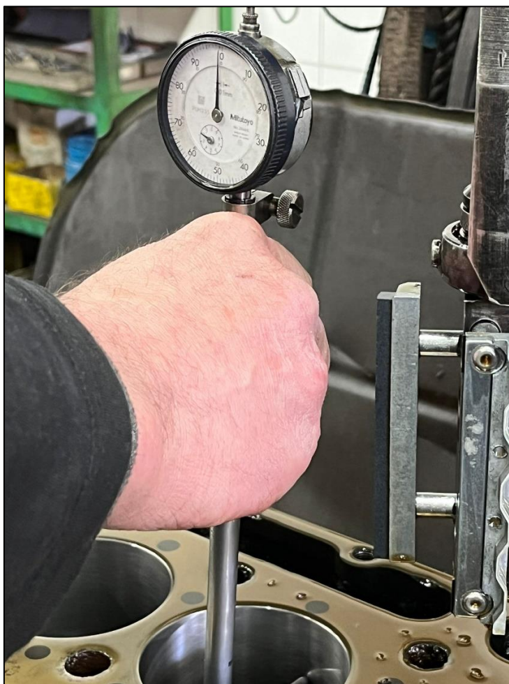
Slika 33. Mjerenje finalne obrade štapnom mjernom urom.
