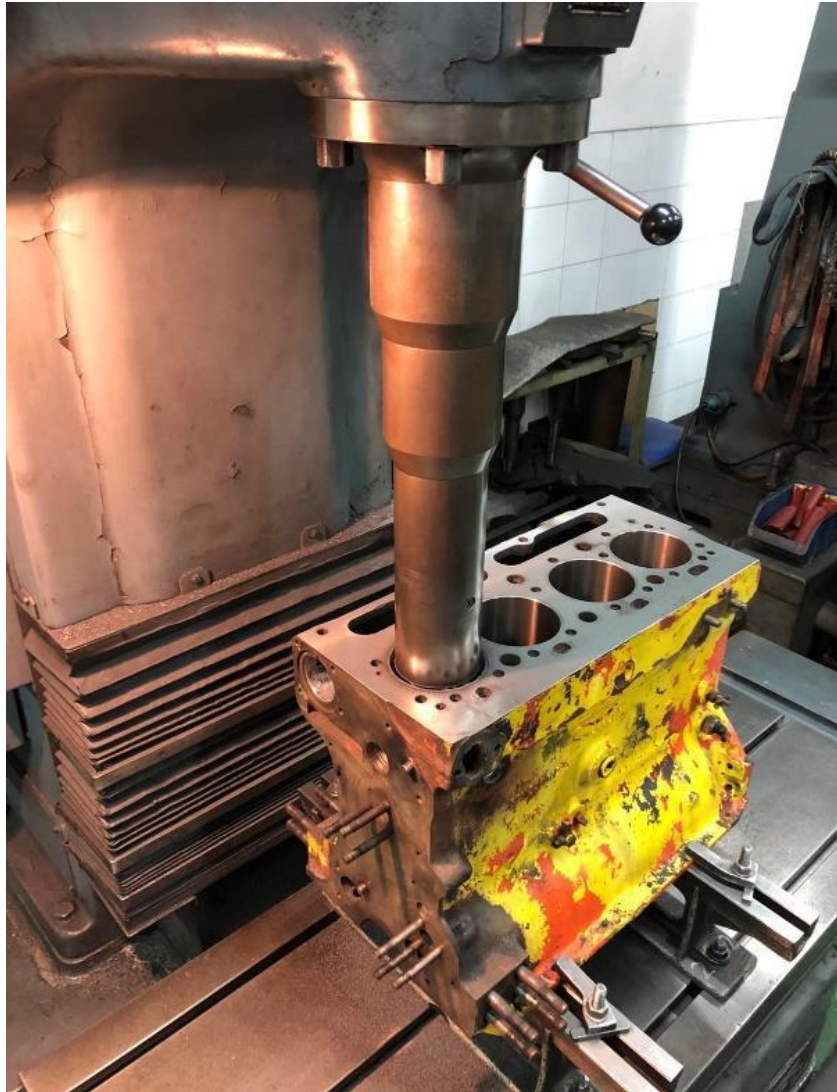
Slika 27. Spuštanje glave tokarilice u košuljicu cilindra.
