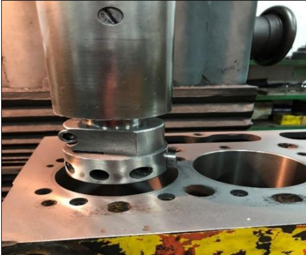
Slika 26. Nož i glava tokarilice
