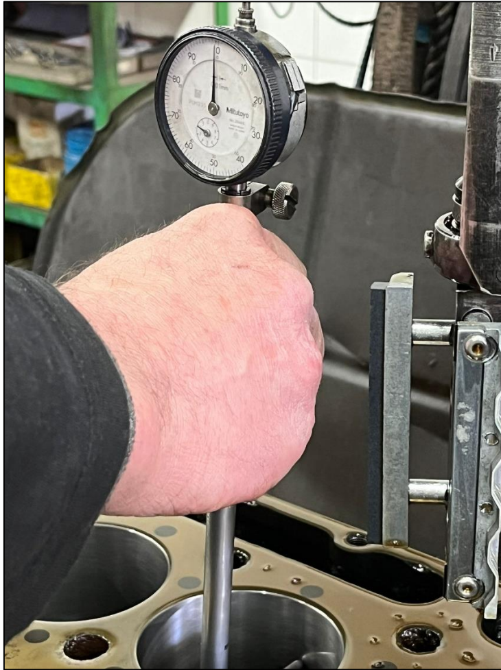
Slika 33. Mjerenje finalne obrade štapnom mjernom urom.
