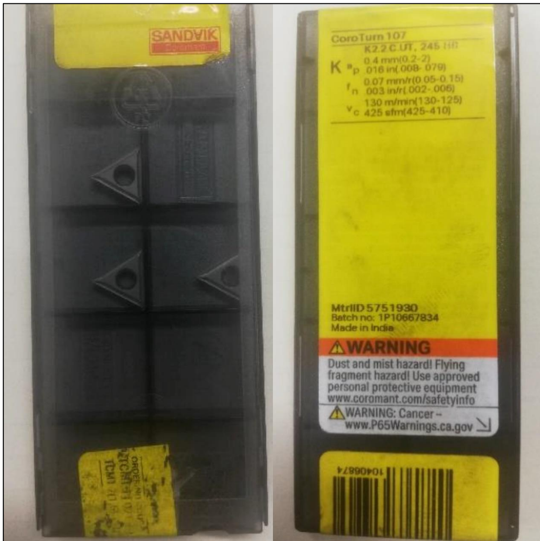
Slika 28. Noževi korišteni za obradu i njihovi parametri.
