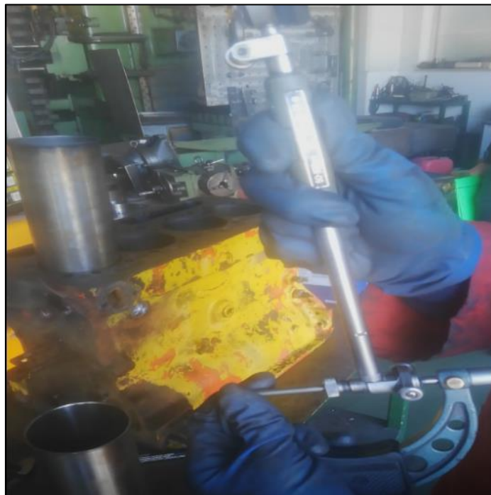
Slika 22. Prijenos vanjskog promjera košuljice sa mjernog mikrometra na štapnu mjernu uru
