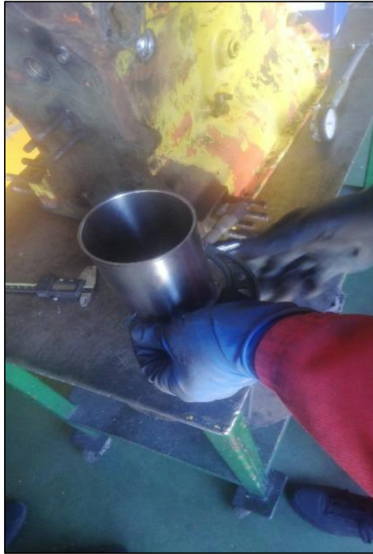
Slika 21. Mjerenje vanjskog promjera košuljice mjernim mikrometrom.
