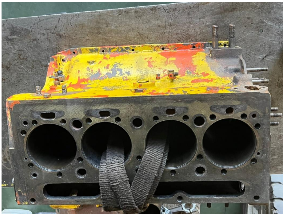
Slika 14. Goli blok motora Perkins D 4.203.
