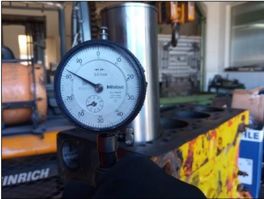
Slika 16. Prvo mjerenje odstupanja.
