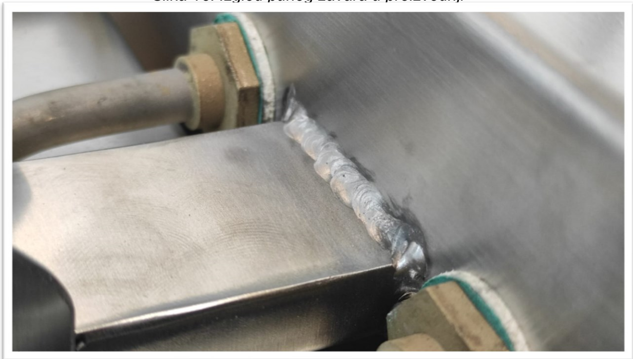
Slika 18. Izgled punog zavara u proizvodnji
