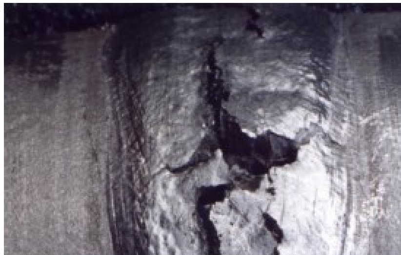
Slika 5. Prikaz nastale pukotine kod austenitnog nehrđajućeg čelika
