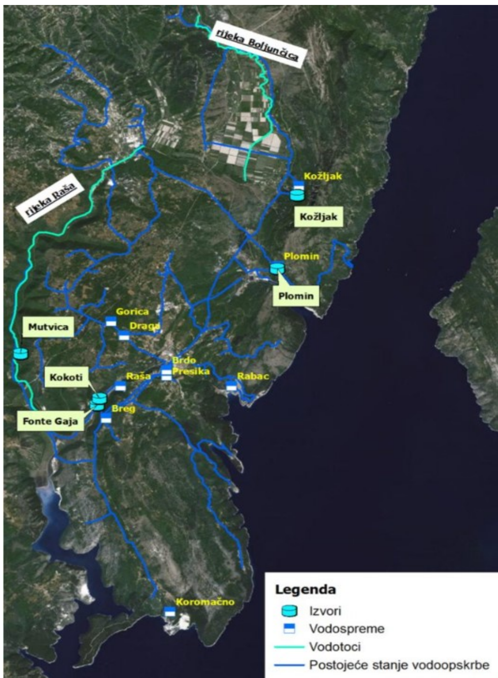
Slika 24. Postojeći sustav vodoopskrbe [19]
