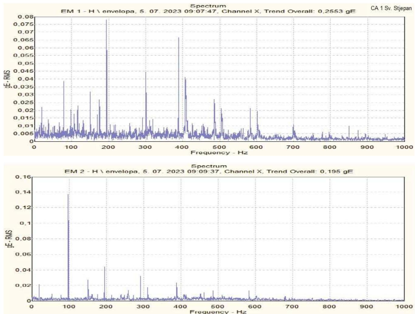
Slika 5.19 Frekvenički spektar envelope H odziva ubrzanja vibracija na položajima EM1 i EM2 CA 1 Sv. Stjepan
