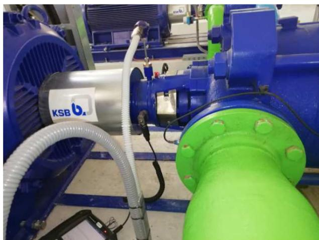
Slika 5.8 Mjerenje vibracija u smjeru H na položaju A CA 4 crpne stanice Sv. Stjepan
