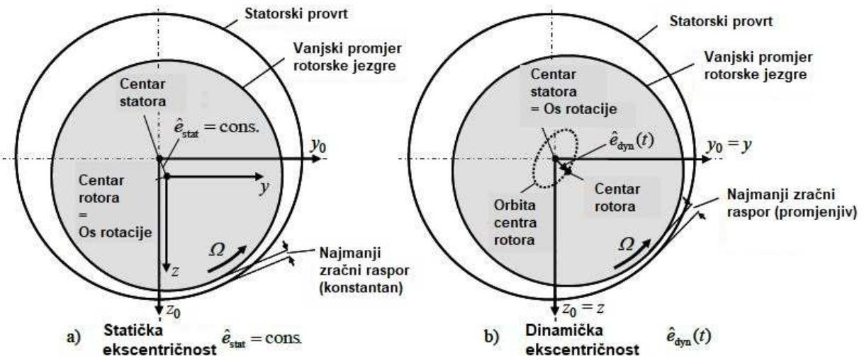
Slika 3.1 Statička i dinamička ekscentričnost rotora kavezognog motora
