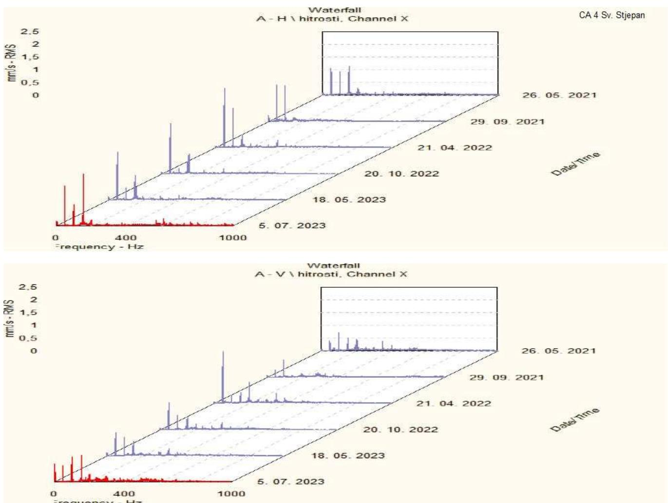
Slika 5.25 Kaskadni prikaz H i V odziva efektivne brzine vibriranja na položaju A CA 4
