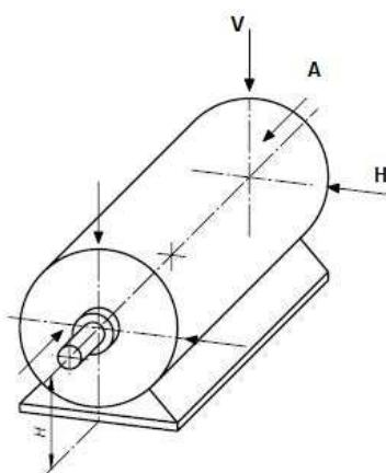
*Slika 4.5 Smjerovi postavljanja senzora vibracija na položajima mjerjenja*
