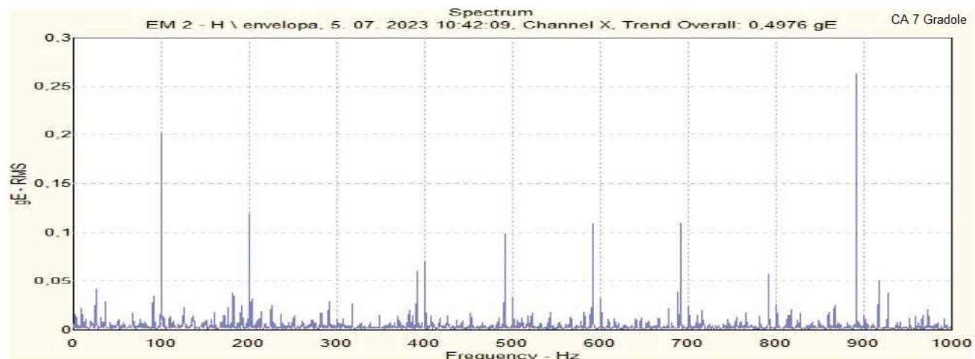
Slika 5.43 Frekvenčni spektar envelope H odziva ubrzanja vibracija na položaju EM2 CA 7 Gradole
