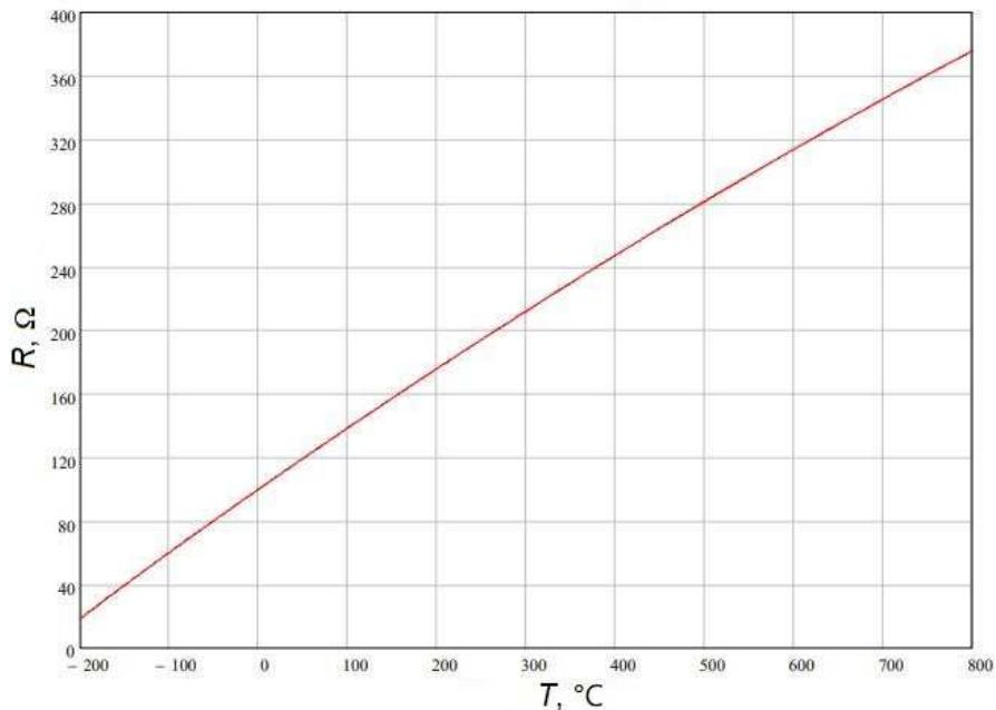
Slika 4.14 Zavisnost otpora o temperaturi Pt - 100 sonde
