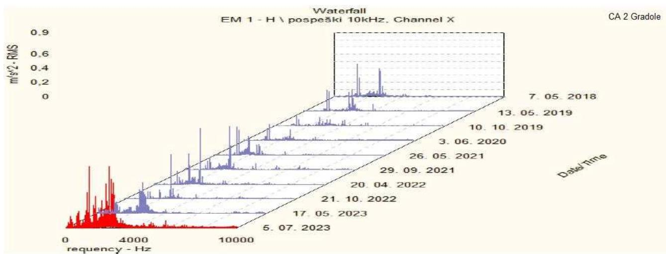
*Slika 5.34 Kaskadni prikaz odziva efektivnog ubrzanja vibracija u smjeru H na položaju EM1 CA 2 Gradole*
