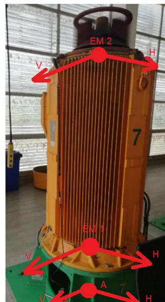
Slika 5.10 Karakteristični položaji i smjerovi mjerjenja vibracija CA crpne stanice
