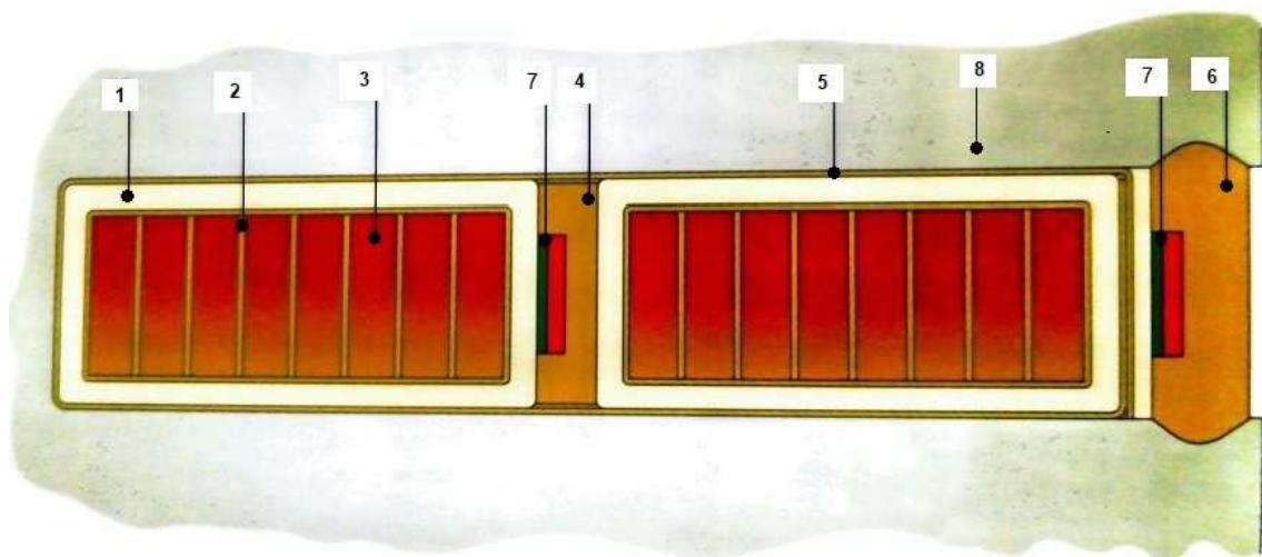
Slika 2.3 Utor statorskog paketa s uloženim izoliranim namotima
