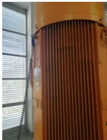
*Slika 5.13 Mjerenje vibracija u smjeru V na položaju EM2 CA 7 crpne stanice Gradole*
