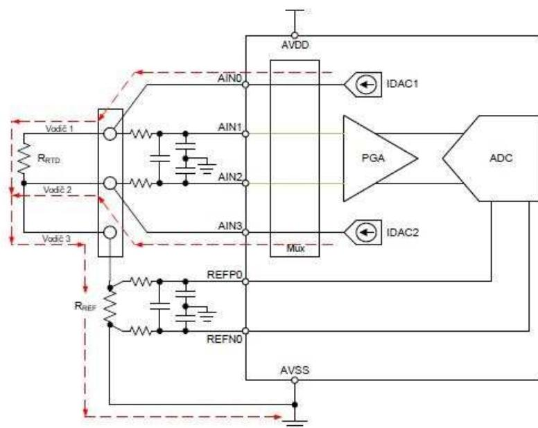
Slika 4.16 Digitalna linearizacija pri mjerenuju temperaturu Pt-100 sondom
