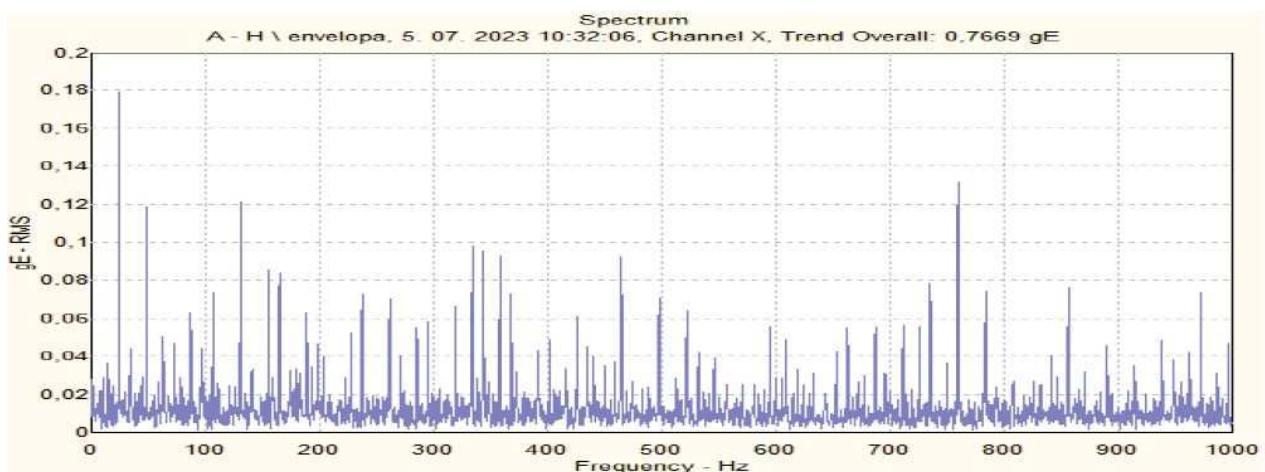
Slika 5.36 Frekvencijski spektar envelope  $H$  odziva ubrzanja vibracija na položaju A
