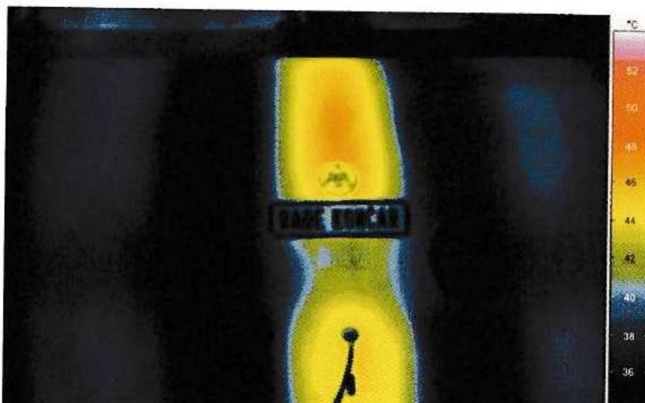
*Slika 4.18 Izlazni rezultat periodičkog nadzora turbogeneratora termografijom*
