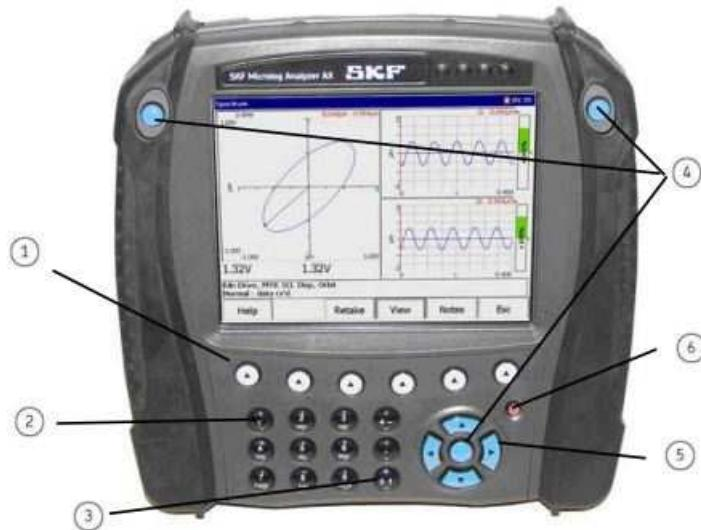
*Slika 5.4 SKF Microlog Analyzer AX vanjska jedinica za obradu signala*
