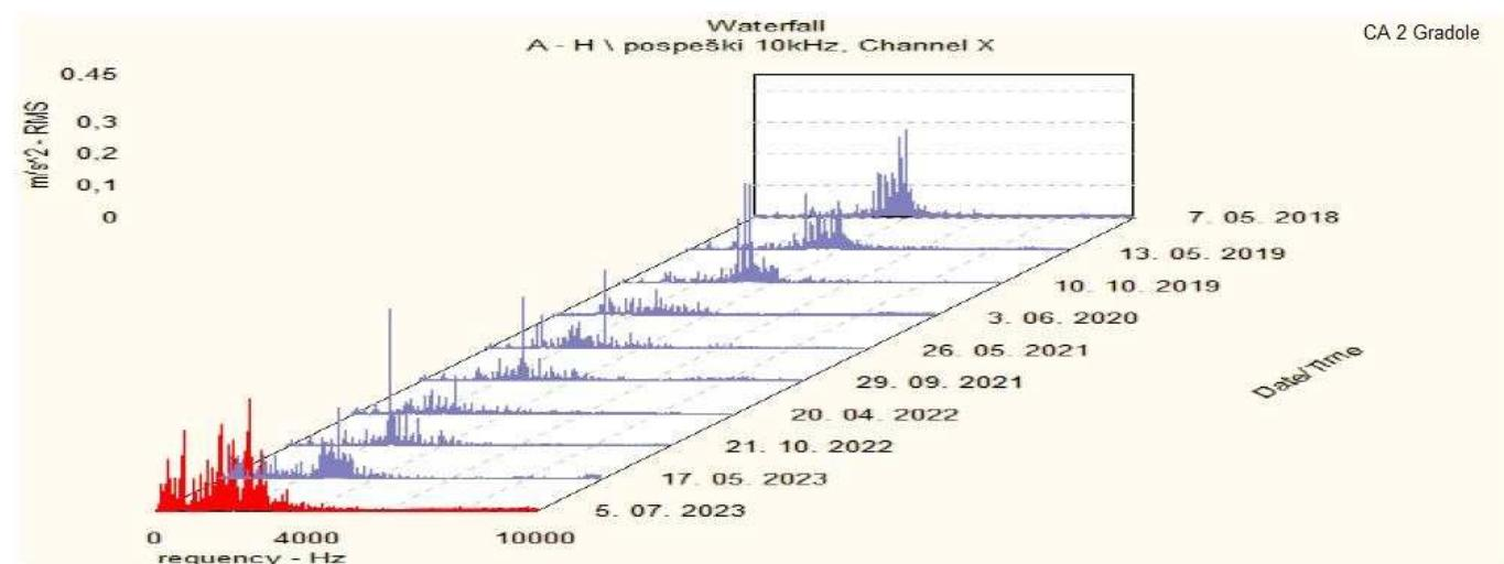
*Slika 5.38 Kaskadni prikaz odziva efektivnog ubrzanja vibracija u smjeru H na položaju A CA 2 Gradole*
