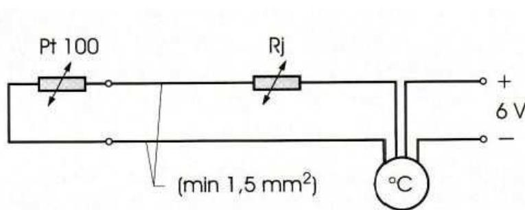
Slika 4.15 Osnovni strujni krug Pt - 100 sonde
