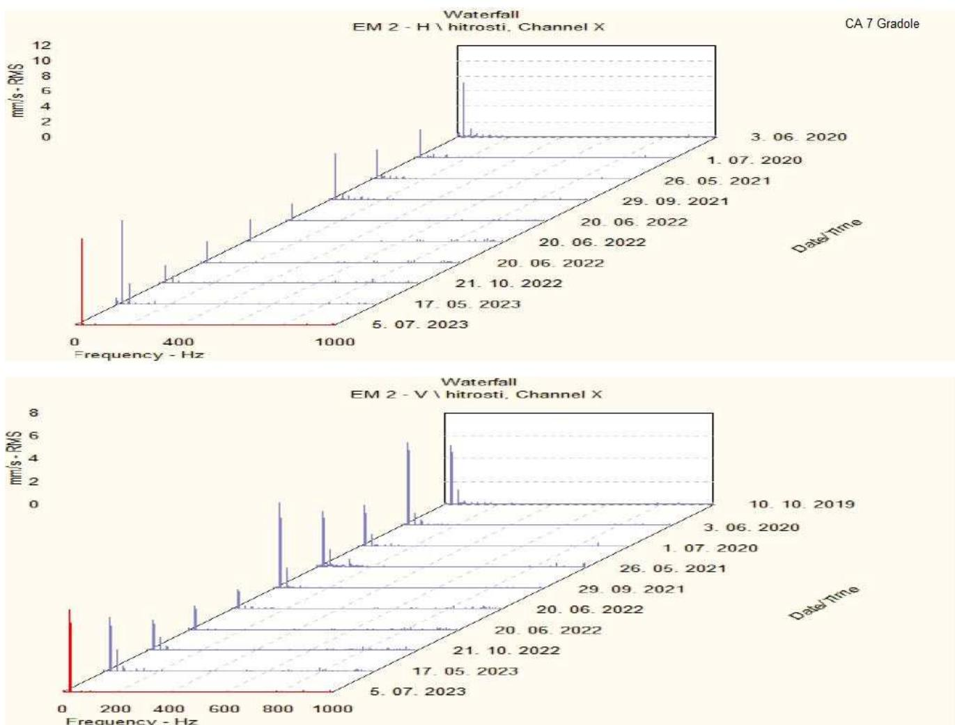
Slika 5.42 Kaskadni prikaz H i V odziva efektivne brzine vibracija na položaju EM2
