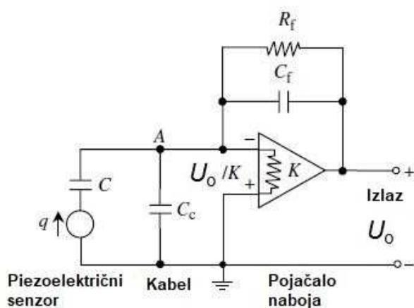
Slika 4.9 Ekvivalentni krug piezoelektričnog senzora spojenog na pojačalo
