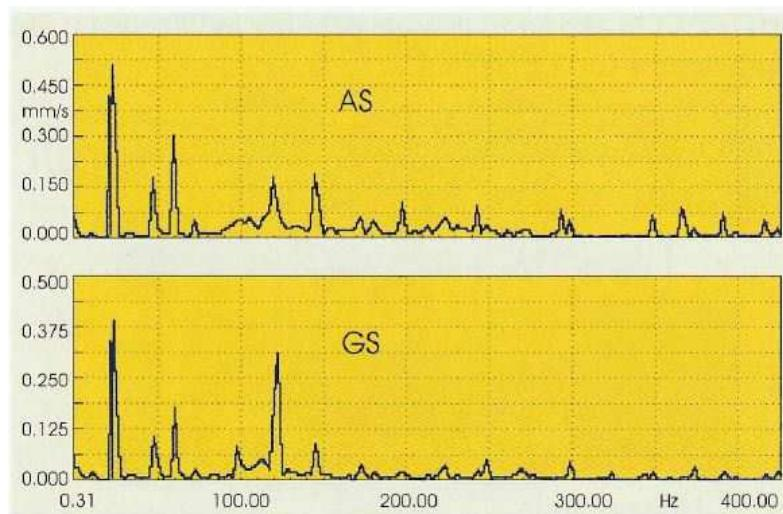
*Slika 4.10 Frekvencijski spektar odziva efektivne brzine vibriranja ležajeva*
