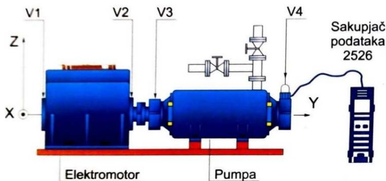
Slika 4.4 Položaji mjerjenja vibracija u sustavu elektromotornog pogona
