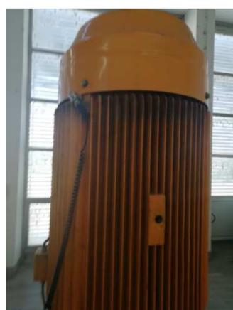
*Slika 5.12 Mjerenje vibracija u smjeru H na položaju EM2 CA 2 crpne stanice
