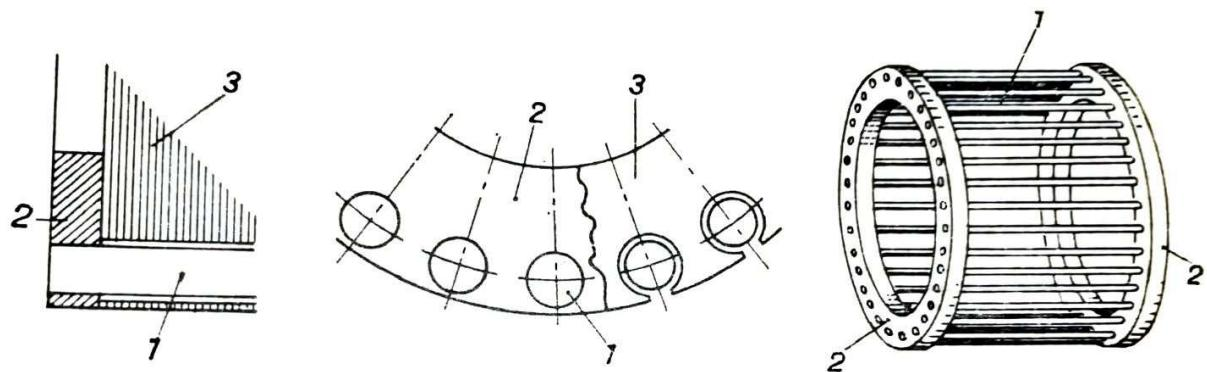
Slika 2.4 Rotorski namot kavezognog motora
