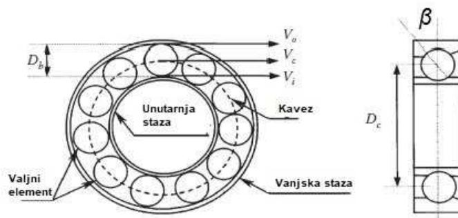
*Slika 3.2 Geometrijske karakteristike valjnih ležajeva*
