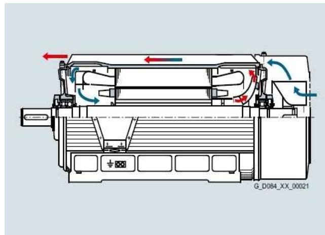
*Slika 2.11 Strujanje zraka IC411 izvedbe samo-ventilirajućeg sustava hlađenja*
