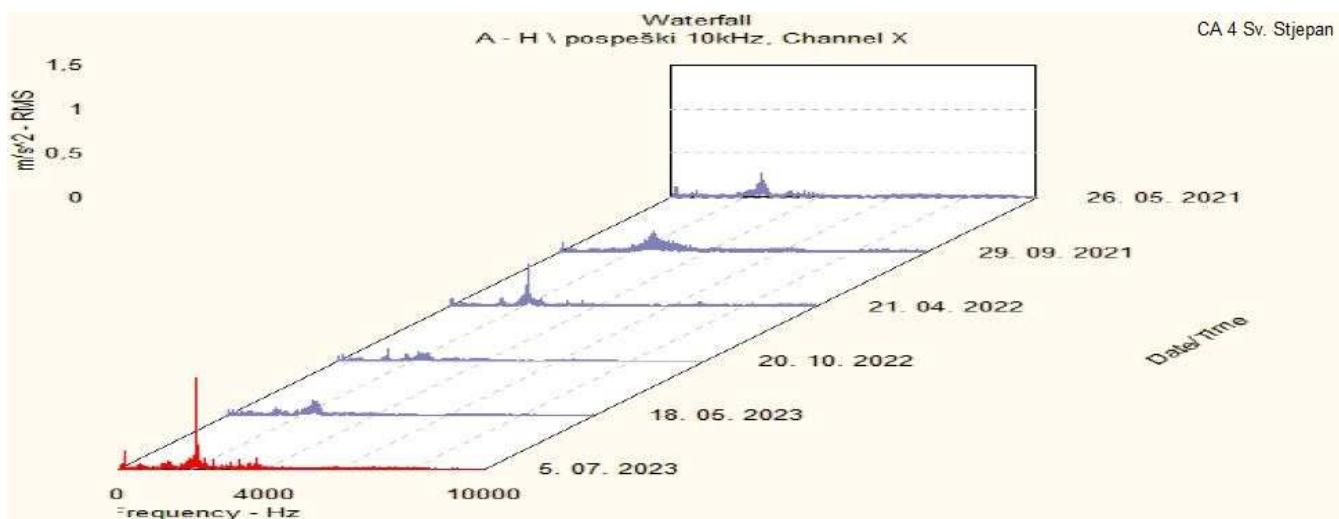
Slika 5.29 Kaskadni prikaz odziva efektivnog ubrzanja vibracija u smjeru  $H$  na položaju A CA 4
