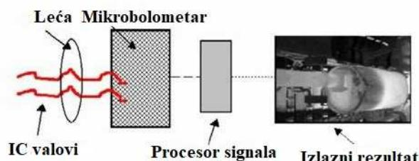
*Slika 4.17 Blok shema termografske kamere*
