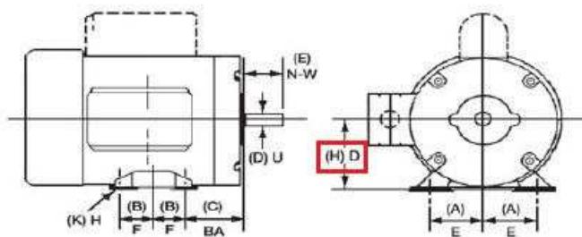
Slika 2.13 Označavanje visine osi kavezognog motora
