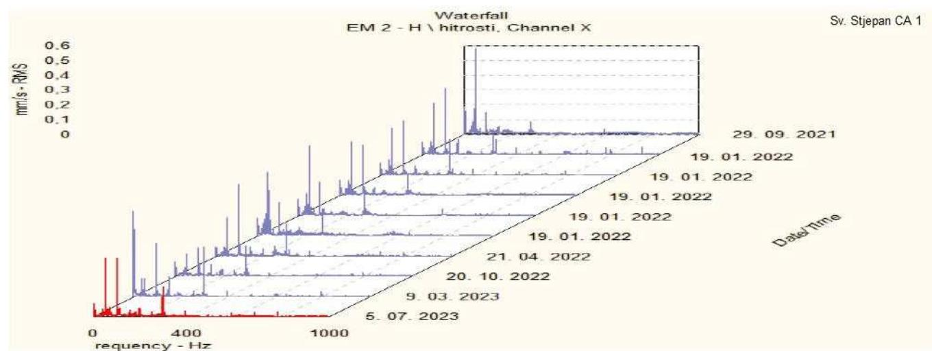
*Slika 5.18 Kaskadni prikaz H odziva efektivne brzine vibriranja na položaju EM2 CA 1*
