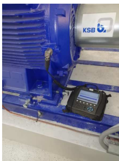
Slika 5.6 Mjerenje vibracija u smjeru H na položaju EM1 CA 1 crpne stanice Sv. Stjepan
