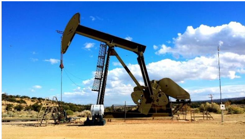
Slika 3. Pumpa korištena u petrokemijskoj industriji za izvlačenje nafte i zemnog plina iz zemljine kore
