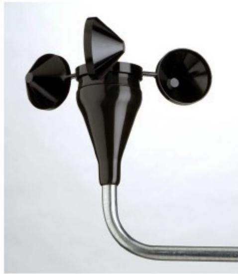
Slika 13. Cup anemometar postavljen na nosaču
