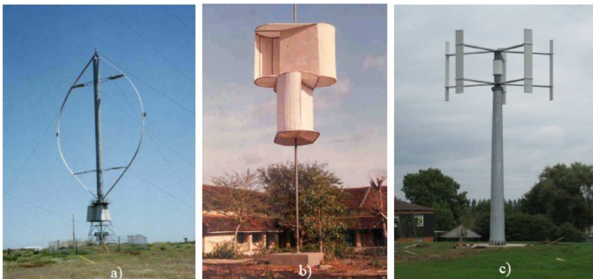
Slika 24. Različiti tipovi vjetroturbina sa vertikalnom osovinom a) Darriusova vjetroturbina; b) Savoniusova vjetroturbina; c) H vjetroturbina
