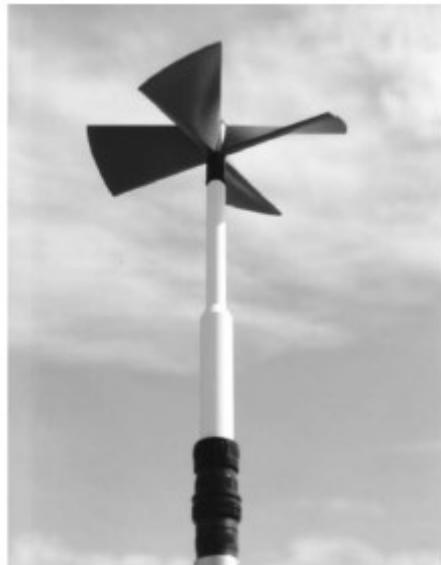
Slika 14 Propelerni anemometar za mjerjenje vertikalne komponente brzine vjetra
