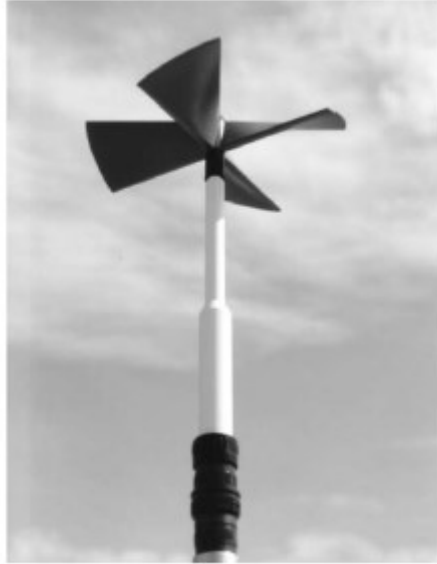
Slika 14 Propelerni anemometar za mjerenje vertikalne komponente brzine vjetra
