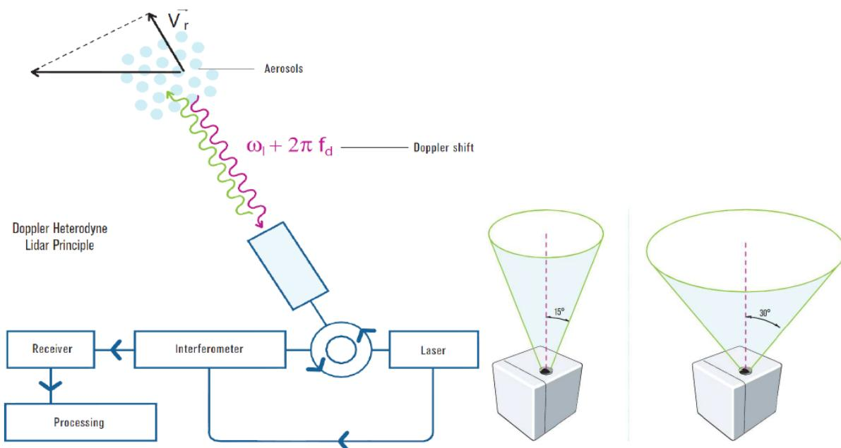
Slika 16 Shematski prikaz principa rada laser-doppler (LIDAR) sustava
