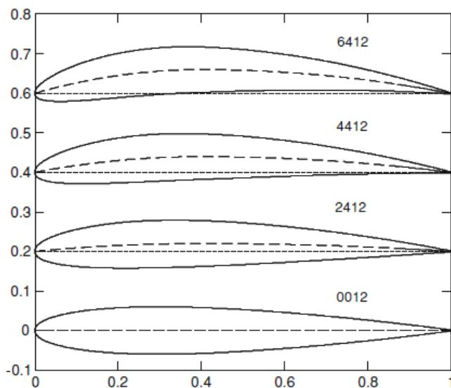
Slika 30. Aeroprofili označeni prema NACA standardu
