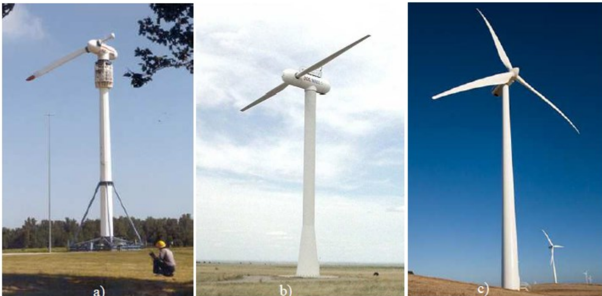
Slika 25. Različiti tipovi vjetroturbina velikih snaga sa horizontalnom osovinom: a) vjetroturbine sa jednom lopaticom i utegom; b) vjetroturbina sa dvije lopatice; c) vjetroturbina sa tri lopatice
