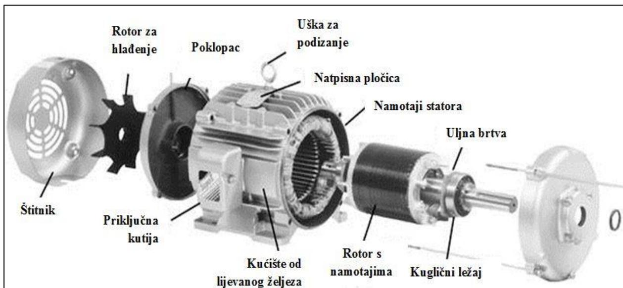
Slika 17. Elektromotor (izvor: 6 najčešćih kvarova elektromotora – Strojarska radionica)
