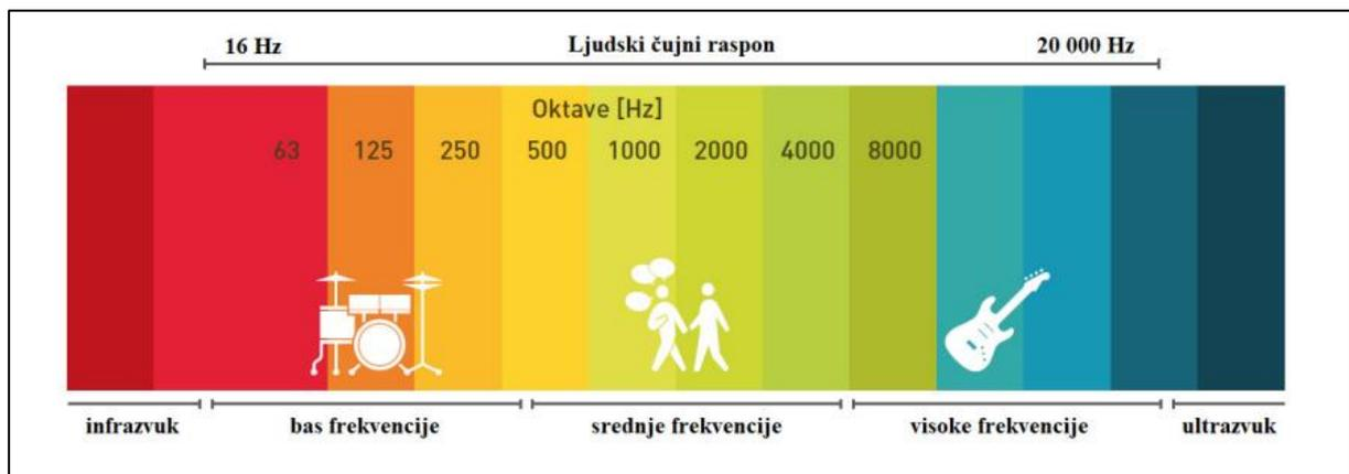
Slika 1. Raspon frekvencija (izvor: katalog Rockwool zvučna izolacija)
