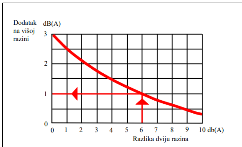
Slika 16. Zbrajanje razine buke sa više izvora (izvor: Trbojević, 2011.)
