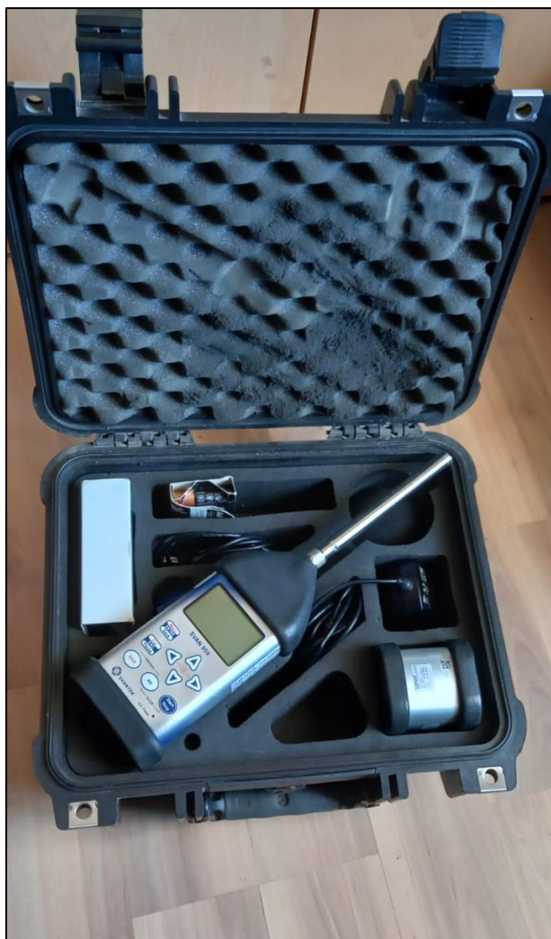
Slika 9. Zvukomjer (izvor: izrada autora)
