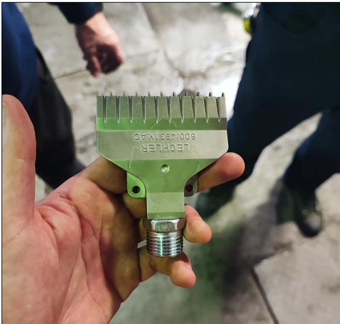
Slika 23. Prigušnica (izvor: izradio autor)
