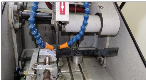
Slika 5. Rezanje uz dodatak emulzije.
