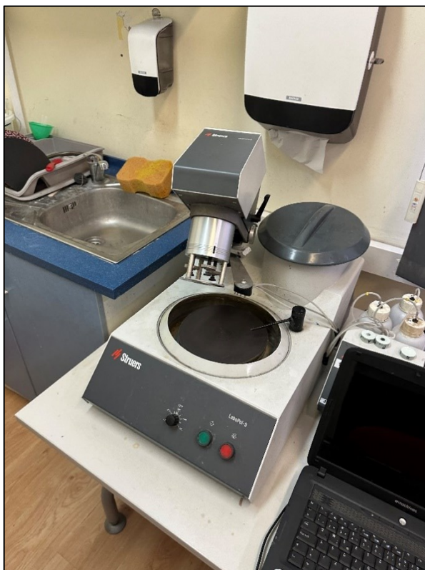
Slika 10. Uređaj za brušenje/poliranje uzoraka.
