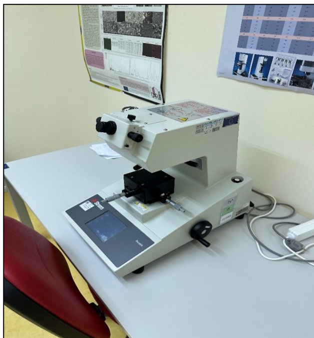
Slika 11. Tvrdomjer DURAMIN 2 tvrtke STRUERS.
