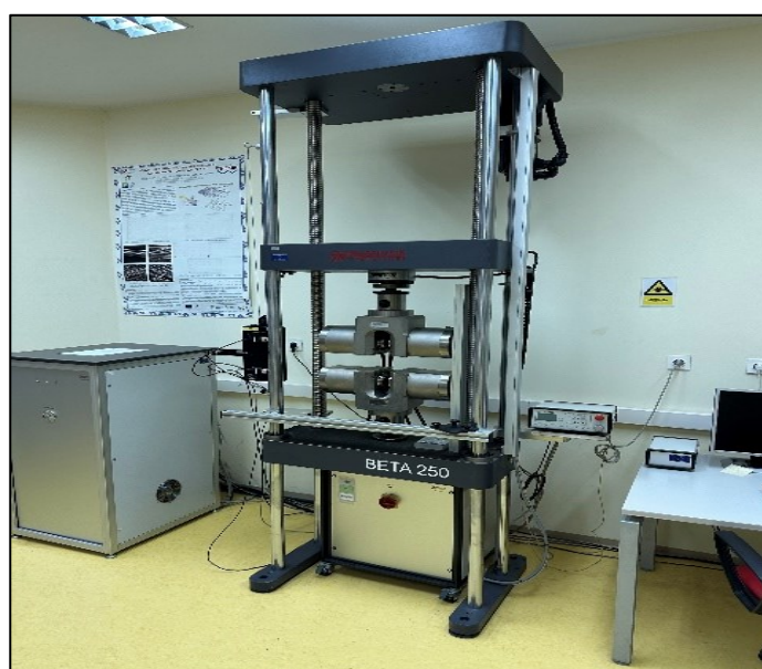
Slika 16. Statička kidalica BETA 250 tvrtke Messphysik.
