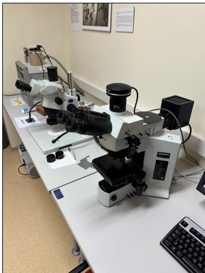
Slika 20. BX51 metalografski mikroskop tvrtke OLYMPUS.
