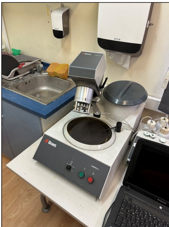
Slika 10. Uređaj za brušenje/poliranje uzoraka.
