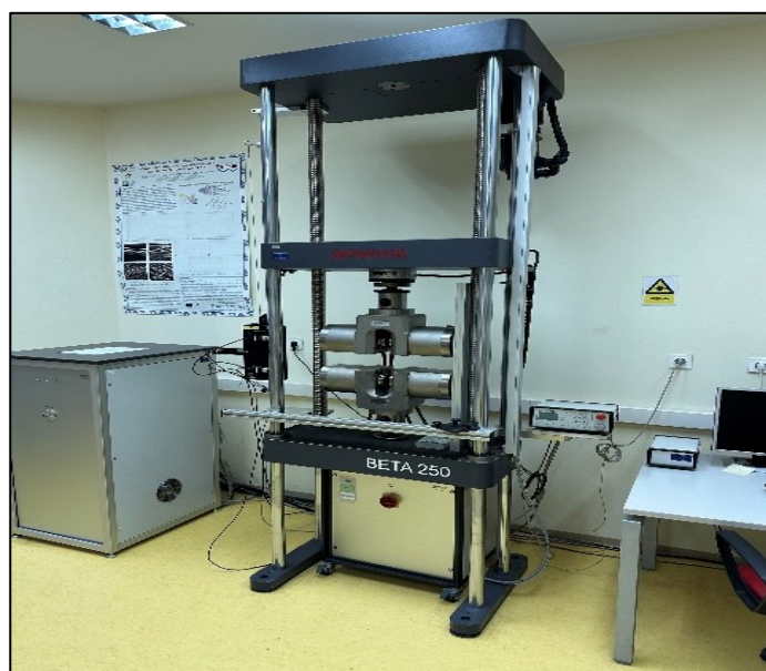
Slika 16. Statička kidalica BETA 250 tvrtke Messphysik.
