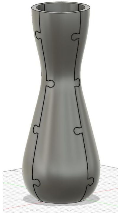
Slika 45. Prikaz modela podijeljenog na 4 dijela
