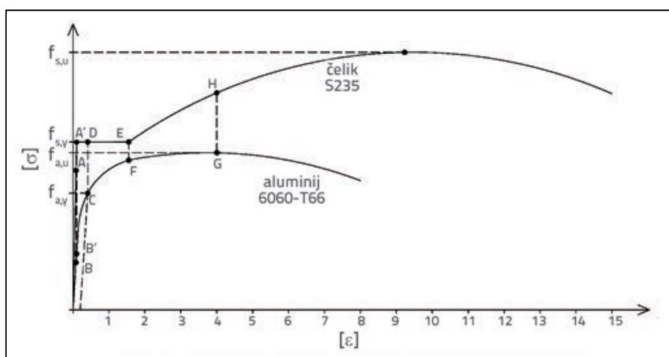
Slika 5. Usporedba čelika i aluminija u dijagramu naprezanja  $\sigma$ - $\epsilon$
