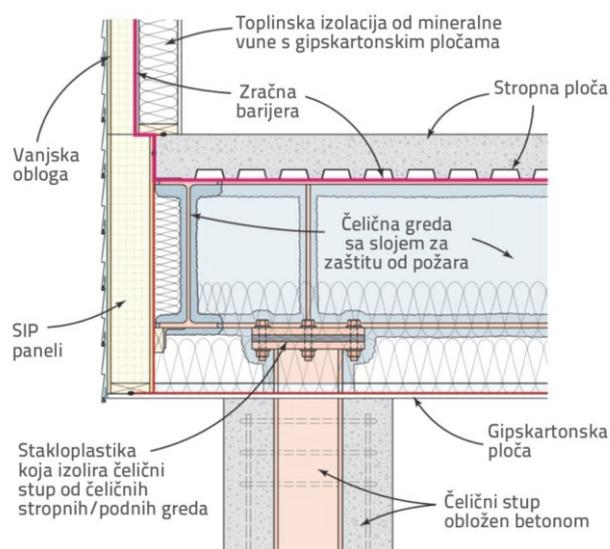
Slika 3. Primjer pravilno postavljene zvučne i toplinske izolacije
