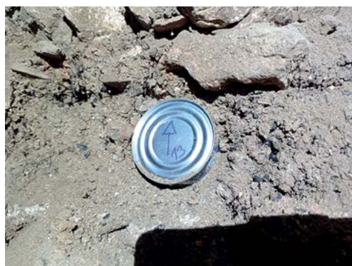
Slika 93b: Uzorak za mikromorfološku analizu prikupljen kutijom.
