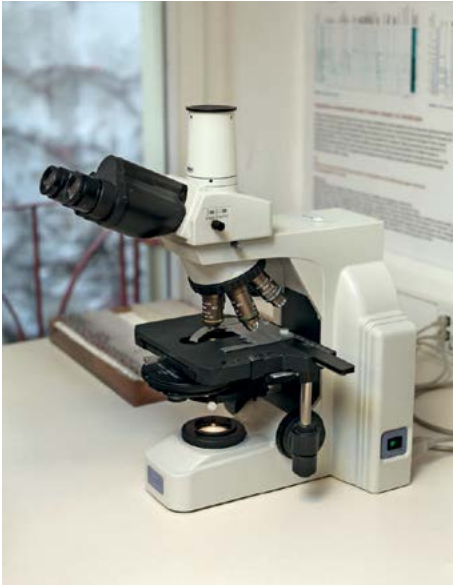
Slika 19: Za prebrojavanje peluda koristimo svjetlosni mikroskop Nikon Eclipse E400 s povećanjem od četiristo puta.
