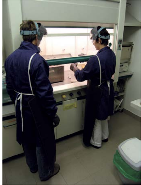
Slika 17: Osobna zaštitna oprema pri radu s fluorovodičnom kiselinom. Palinološki laboratorij Instituta za arheologiju ZRC-a SAZU-a. Foto: T. Nagel.
