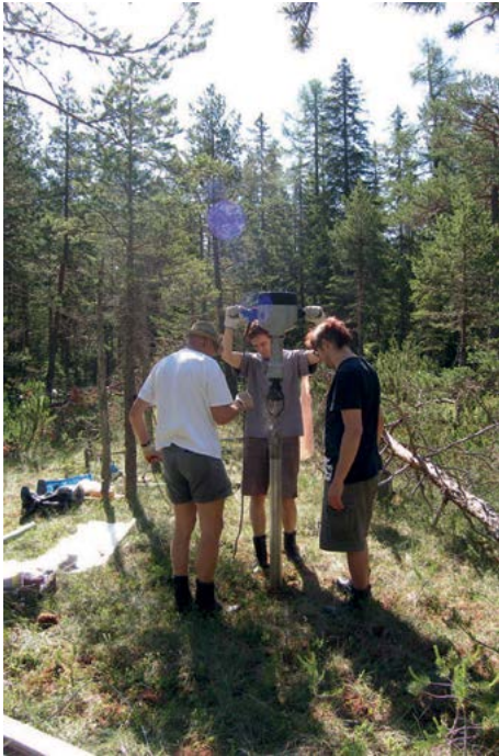
Slika 9: Palinološko bušenje na Covnikovu barju (Solčava). Na Institutu za arheologiju ZRC-a SAZU-a upotrebljavamo „Stitz” verziju „Livingstone” opreme za bušenje koja je povezana udarnom bušilicom „Makita” i prijenosnim generatorom.
