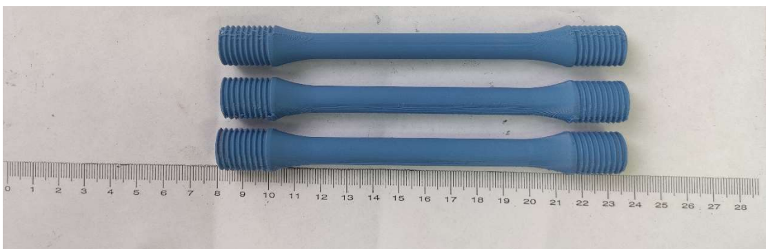
Slika 9: Epruveta - PLA materijal
