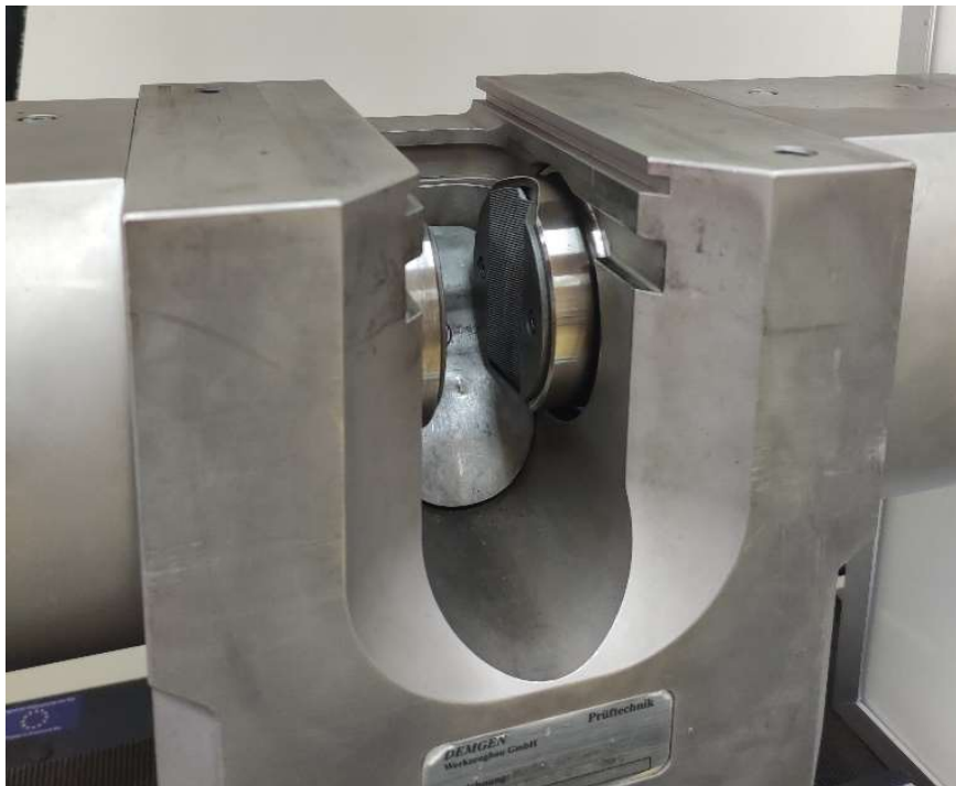
Slika 21: Donja čeljust kidalice
