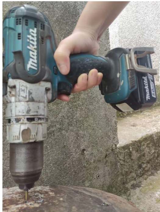
Slika 67: Bušenje rupa Makita bušilicom spojenom na makita bateriju
