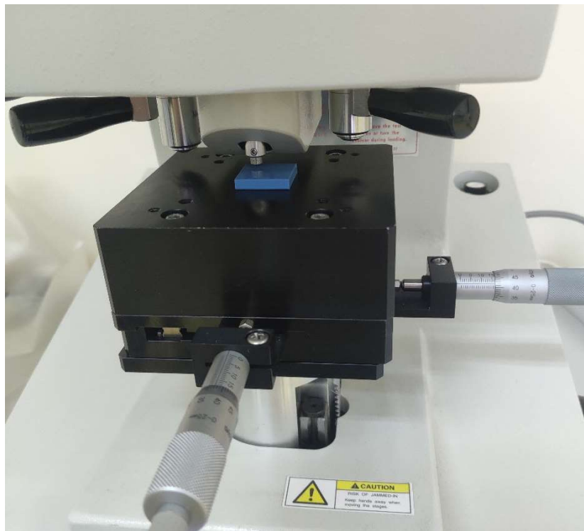
Slika 37: Utiskivanje dijamantne piramide u pločicu materijala
