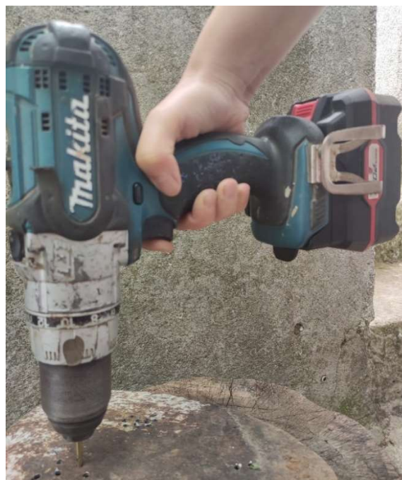
Slika 68: Bušenje rupa Makita bušilicom spojenom na Parkside bateriju spojnim elementom
