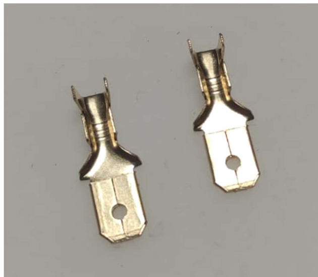
Slika 52: Stopice za dio spojnog elementa za Parkside bateriju
