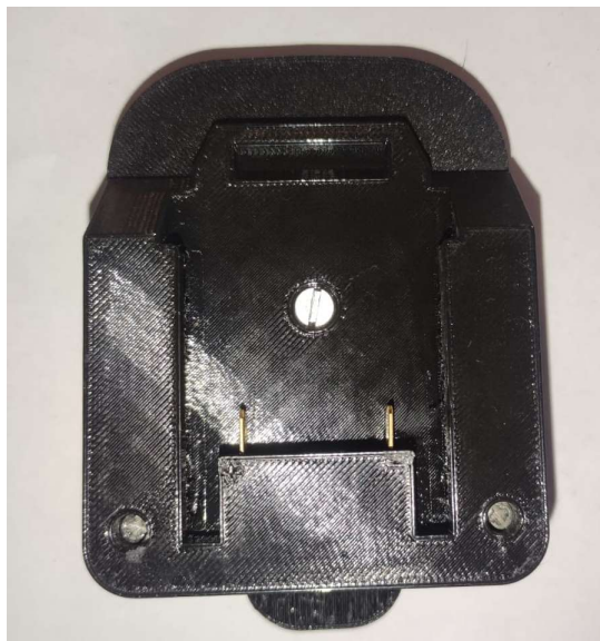
Slika 62: Dijelovi spojnog elementa spojeni šarafima
