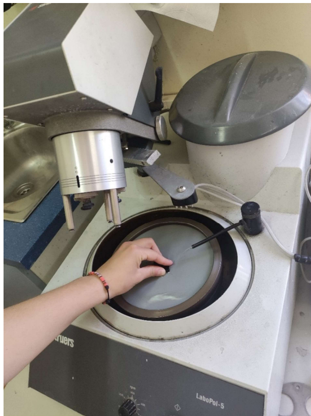
Slika 36: Poliranje materijala za ispitivanje tvrdoće
