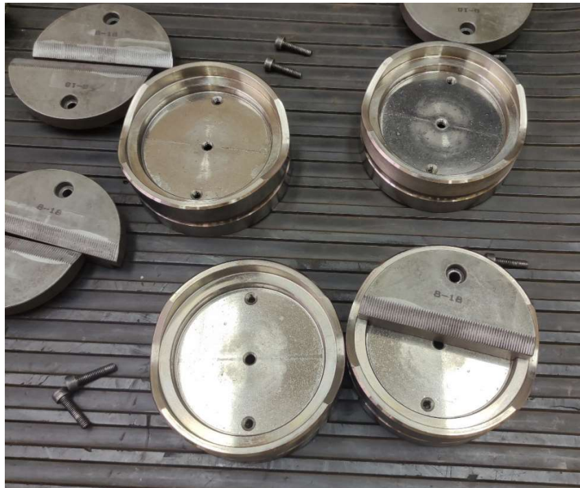
Slika 20: Dijelovi čeljusti kidalice
