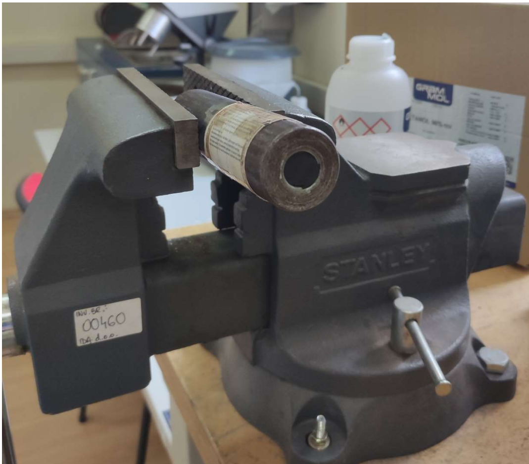
Slika 28: Zaglavljani dio navoja epruvete u držaču kidalice ( PET G)
