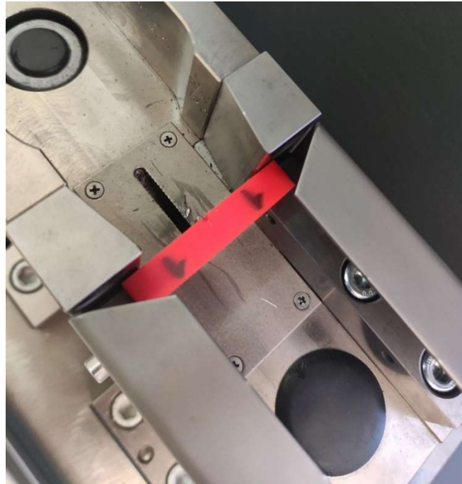
Slika 14: Charpy-jeva epruveta u horizontalnim držačima – ABS
