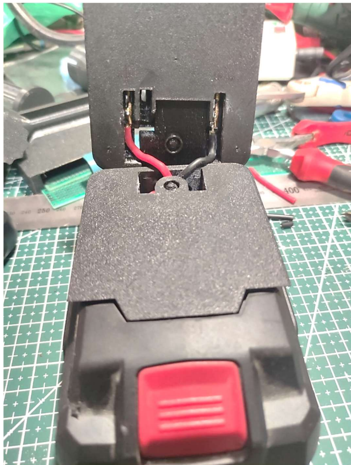
Slika 60: Dijelovi spojnog elementa spojeni žicama i postavljeni na Parkside bateriju
