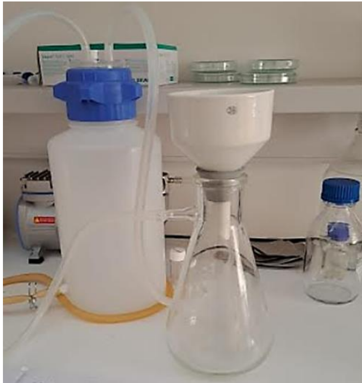
Slika 11. Posložena aparatura za vakuum filtraciju; Büchnerov lijevak, filter papir, boca za odsisavanje, odvodna i dovodna cijev (Izvor: kolegica Turković D.)
