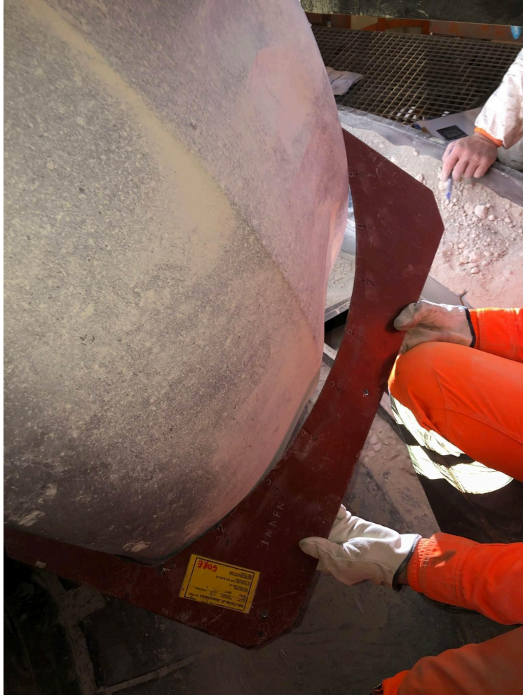
Slika 4.6.3.2. Postupak mjerenja istrošenosti valjka [9]
