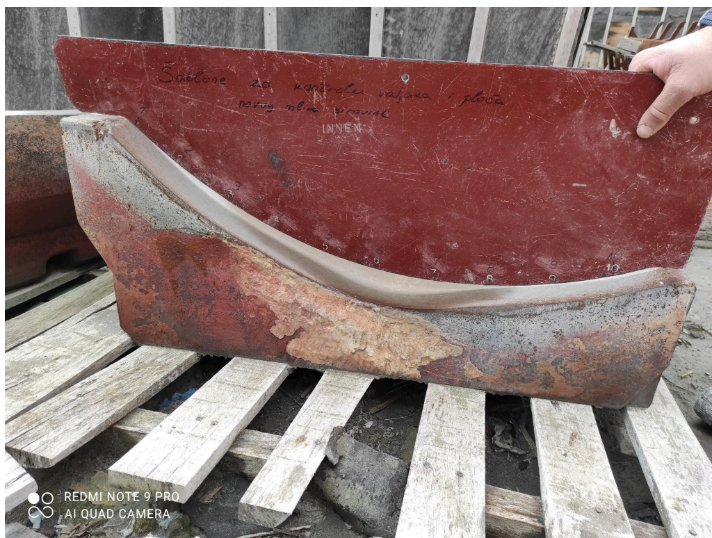
Slika 4.6.3.1. Ravnalo za mjerenje istrošenosti valjka [9]
