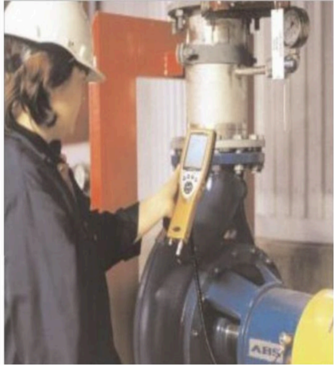
Slika 3.2.2. Mjerenje vibracija danas [15]
