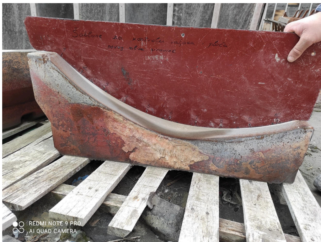
Slika 4.6.3.1. Ravnalo za mjerenje istrošenosti valjka [9]
