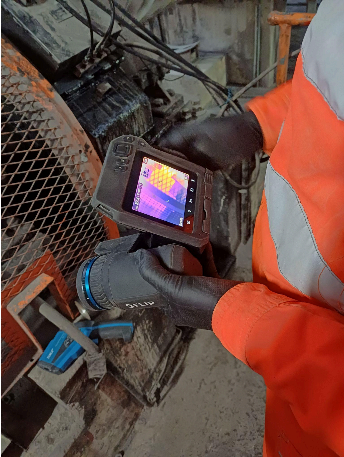
Slika 4.2.3.2. Korištenje infracrvene kamere [9]
