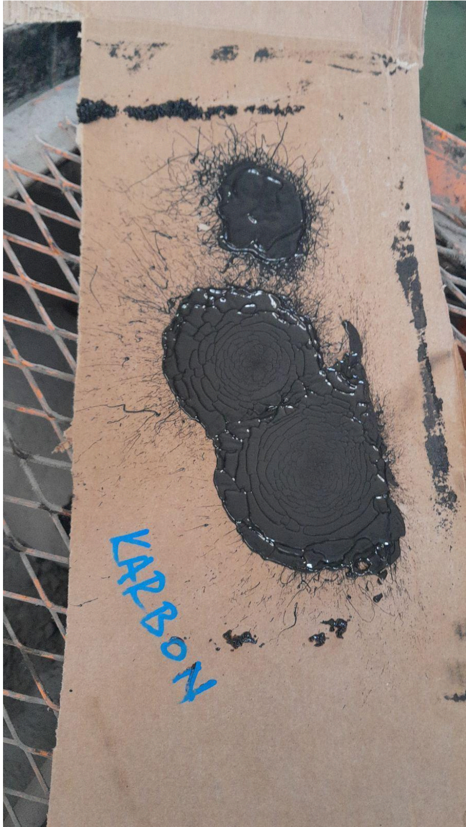
Slika 4.5.3. Spray test mlina ugljena [9]
