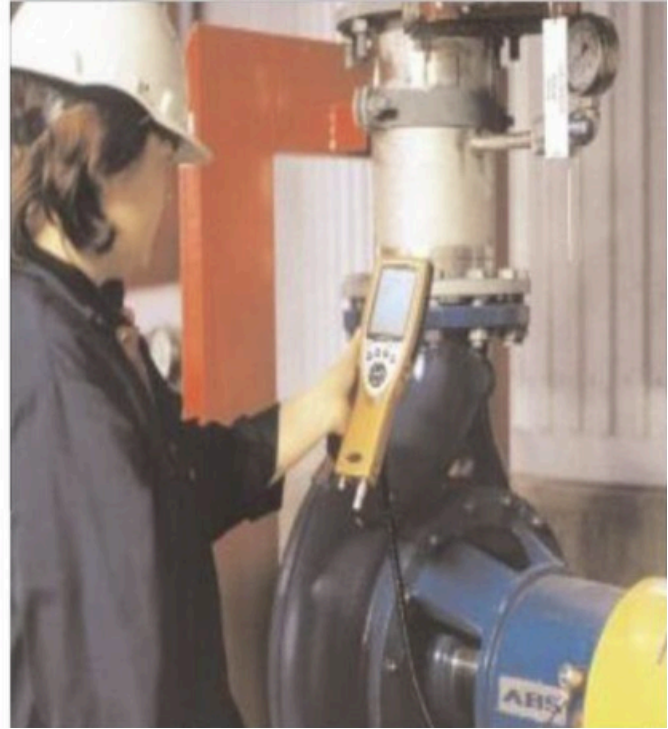
Slika 3.2.2. Mjerenje vibracija danas [15]
