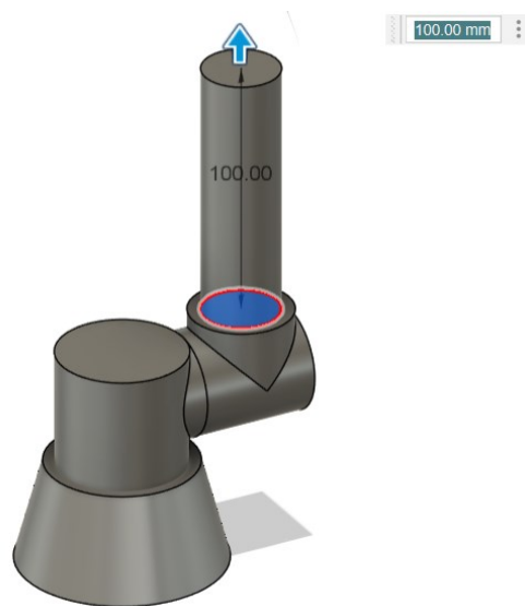
Slika 36 Izrada modela ruke na uzor UR5e 4/7
