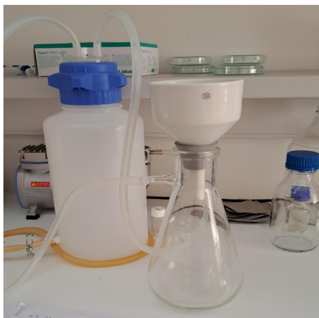
Slika 8. Pribor za vakuum filtraciju
