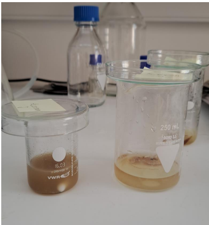
Slika 6. Staklene čase s uzorcima pripremljenim za digestiju
