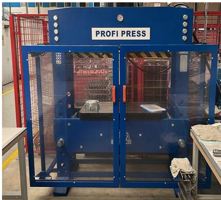
Slika 18. Zaštitna pregrada na preši
