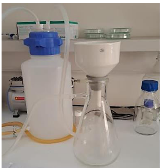
Slika 12. Posložena aparatura za vakuum filtraciju; Büchnerov lijevjak, filter papir, boca za odsisavanje,
