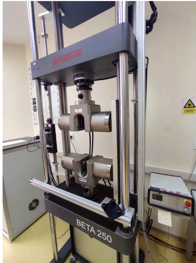
Slika 16: Messphysik Beta 250 univerzalna statička kidalica
