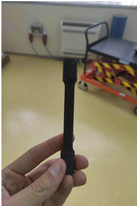
Slika 18: 3D tiskana epruveta za vlačno naprezanje
