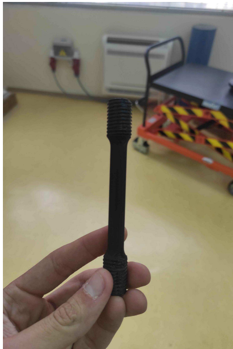
Slika 18: 3D tiskana epruveta za vlačno naprezanje
