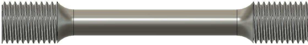
Slika 17: 3D model epruvete za vlačni test
