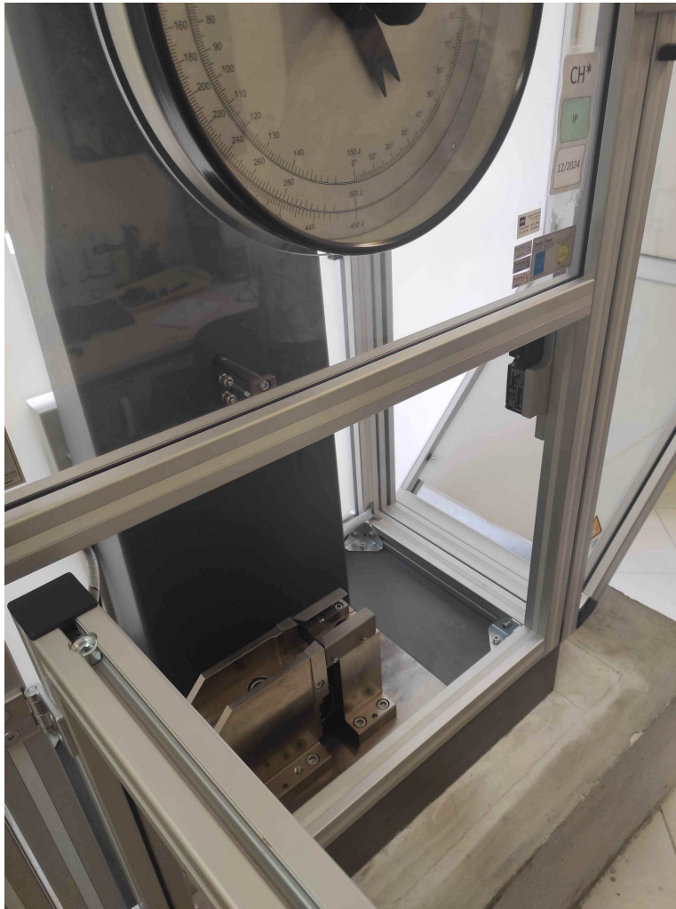
Slika 25: Unutrašnjost ZWICK ROELL RKP450 Charpy-jevog klatna
