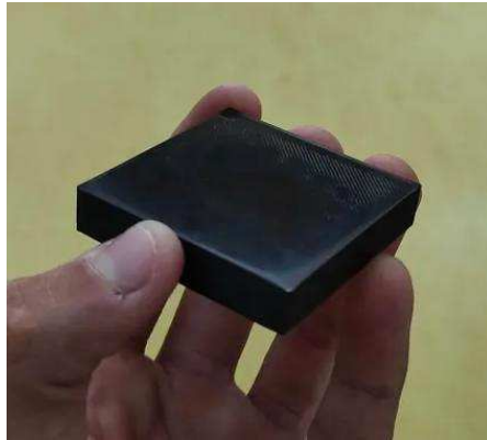
Slika 13: Epruveta za ispitivanje tvrdoće prema Vickersu PLA materijala
