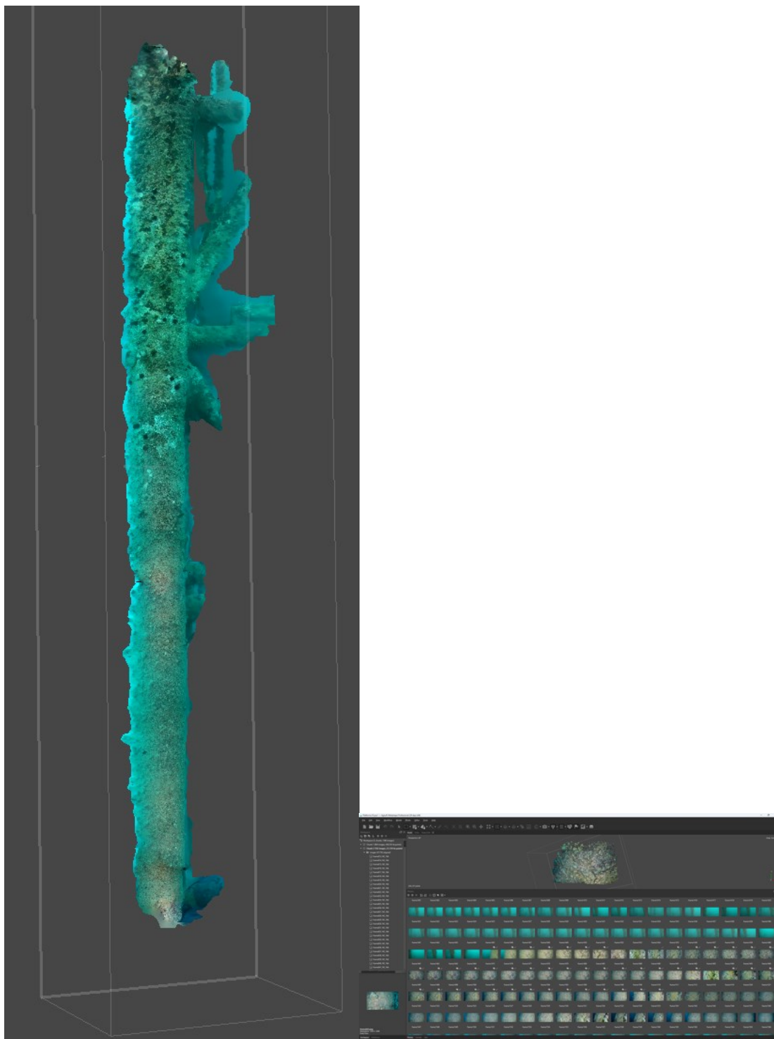
Slika 37. Fotogrametrijska obrada postojećih videa podvodnih dijelova platforme Ivana B (0-40 m).
