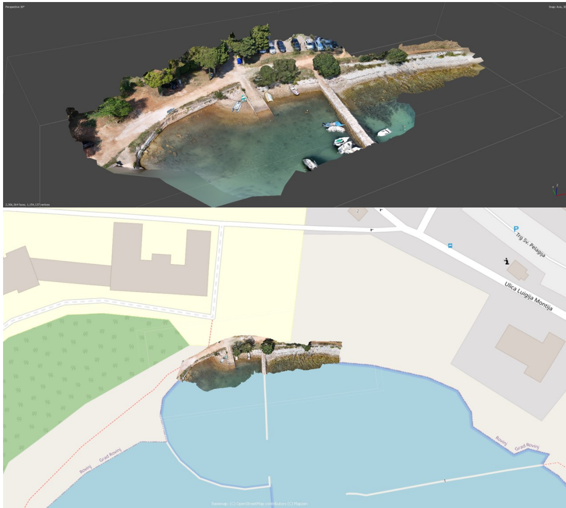
Slika 27. Geolociranje fotogrametrijskog modela male lučice pomoću Agisoft Metashape programa.
