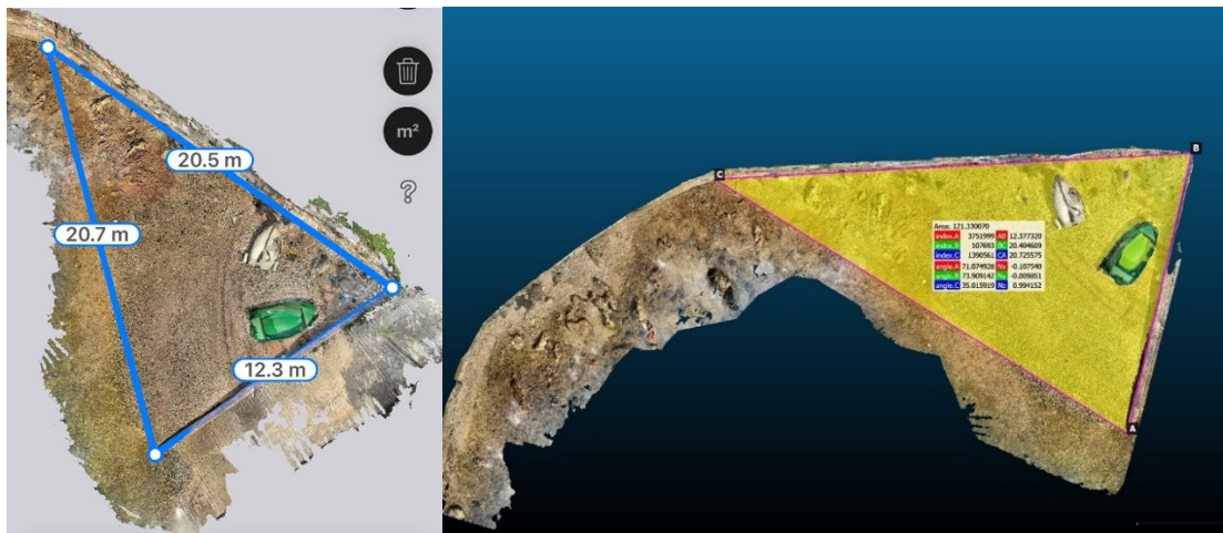
Slika 23. Usporedba jedinica (udaljenosti i površine) prikaza aplikacije 3d Scan App i CloudCompare programa.
