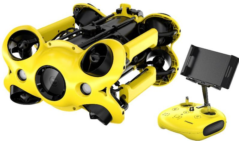
**Slika 13.** ROV Chasing M2 sa opremom.
