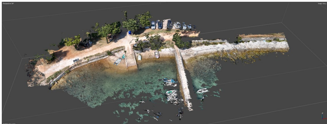
Slika 19. Prikaz generiranog gustog točkastog oblaka male lučice.
