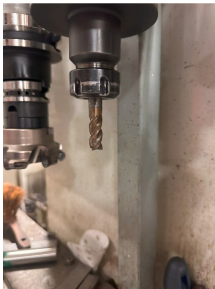
Slika 29. Glodalo za fino glodanje - "šlihter"
