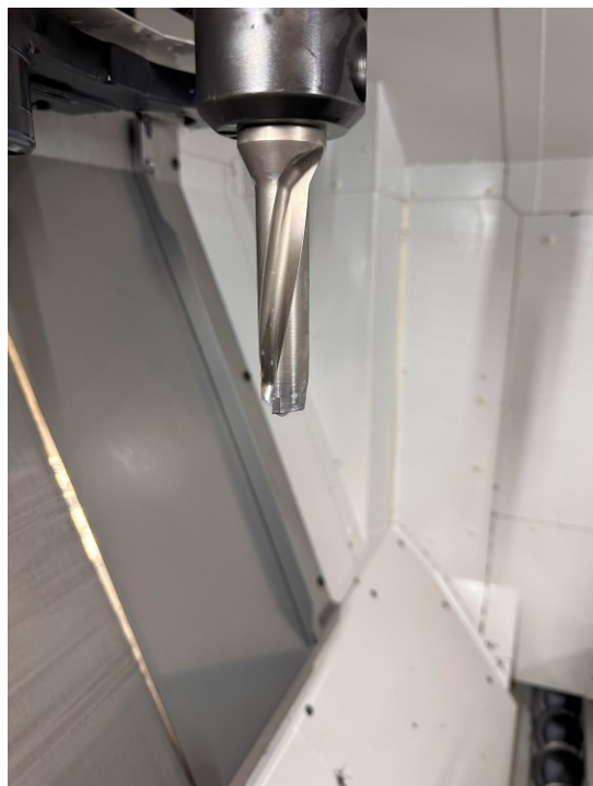
Slika 31. Svrđlo za bušenje rupa sa pločicama
