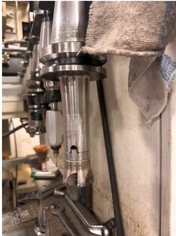
Slika 30. Glodajuća glava sa pločicama - manja
