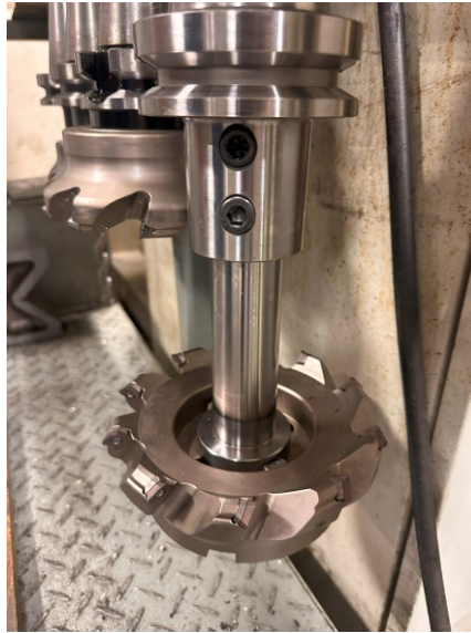
Slika 28. Glodajuća glava sa pločicama - velika
