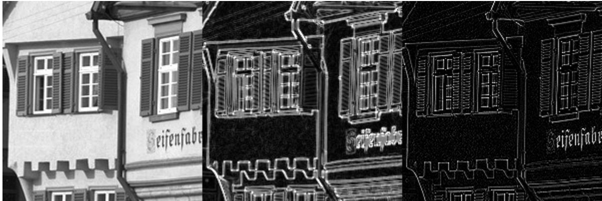
Slika 27. Usporedba debljine rubova između Sobel i Laplace operatora
