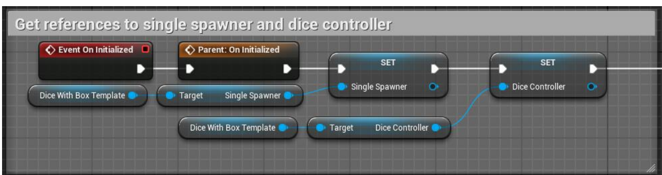
Slika 38. Dohvaćanje referenci iz DiceWithBoxTemplate instance preko funkcije OnInitialized() unutar klase DiceTemplate.
