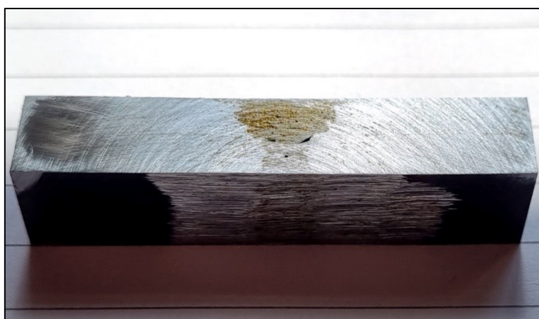
Slika 62. Brušenje (nakon granulacije 4000)
