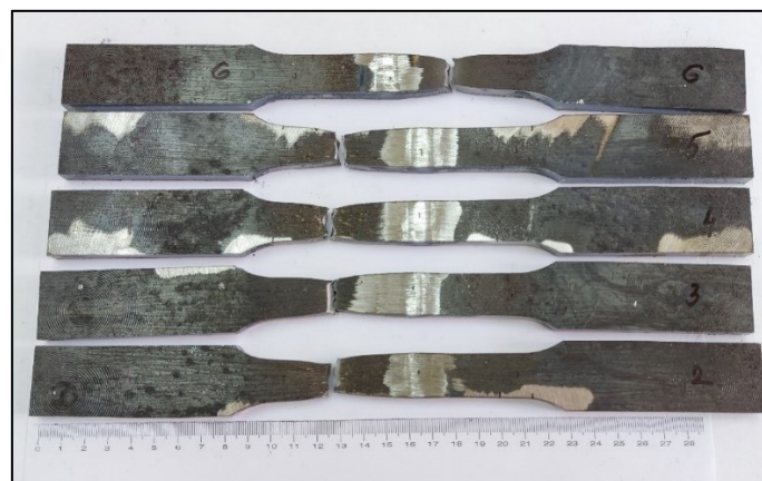
Slika 67. Epruvete nakon vlačnog statičkog ispitivanja
