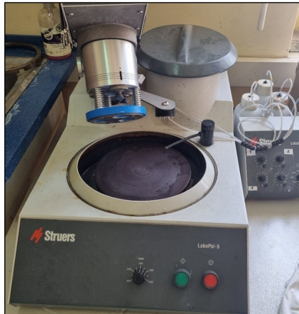
Slika 60. Uređaj za poliranje "STRUERS LaboPol-5"
