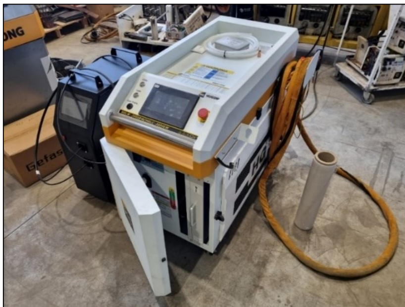
Slika 10. Aparat za zavarivanje "HGLW 3000EW LASER WELDING"
