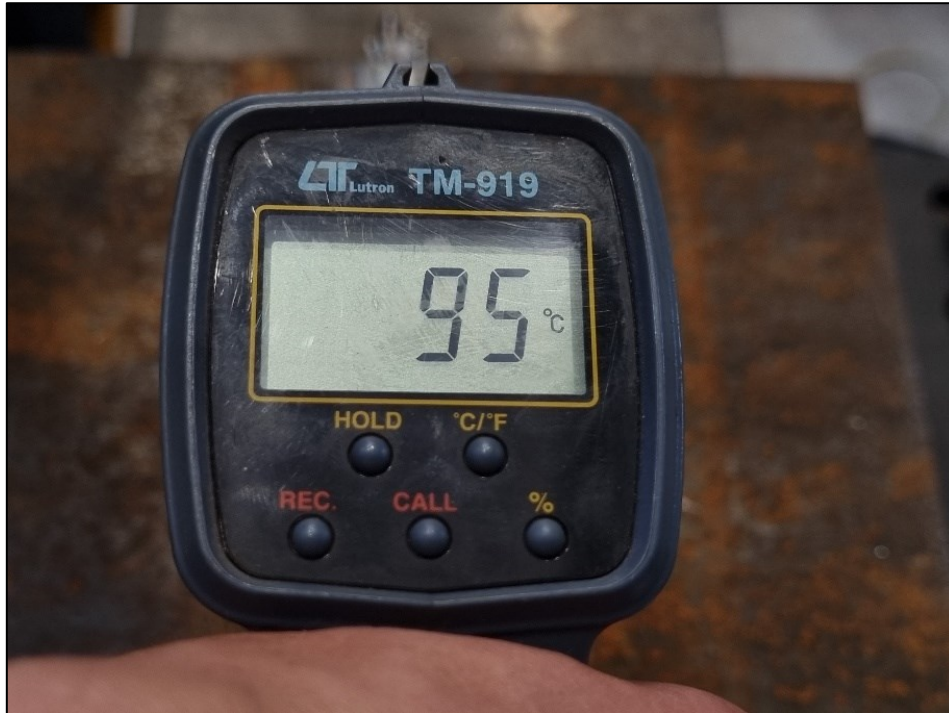
Slika 27. Temperatura nakon 6., 7. i 8. prolaza
