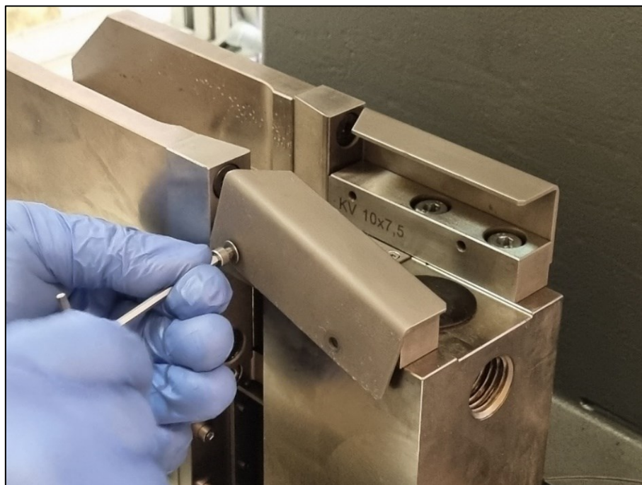
Slika 43. Zamjena držača epruveta (Charpy)
