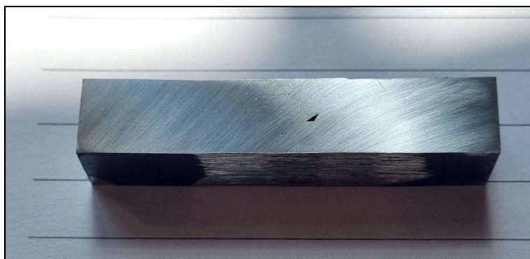
Slika 61. Brušenje (nakon granulacije 1000)
