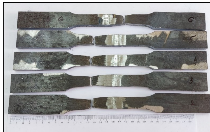
Slika 67. Epruvete nakon vlačnog statičkog ispitivanja
