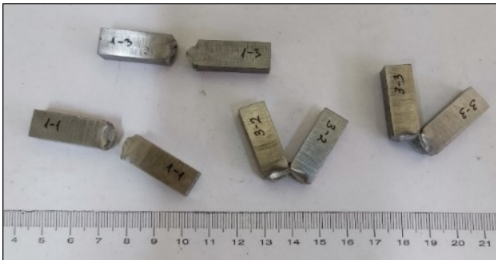
Slika 74. Charpy-jeve epruvete nakon testiranja
