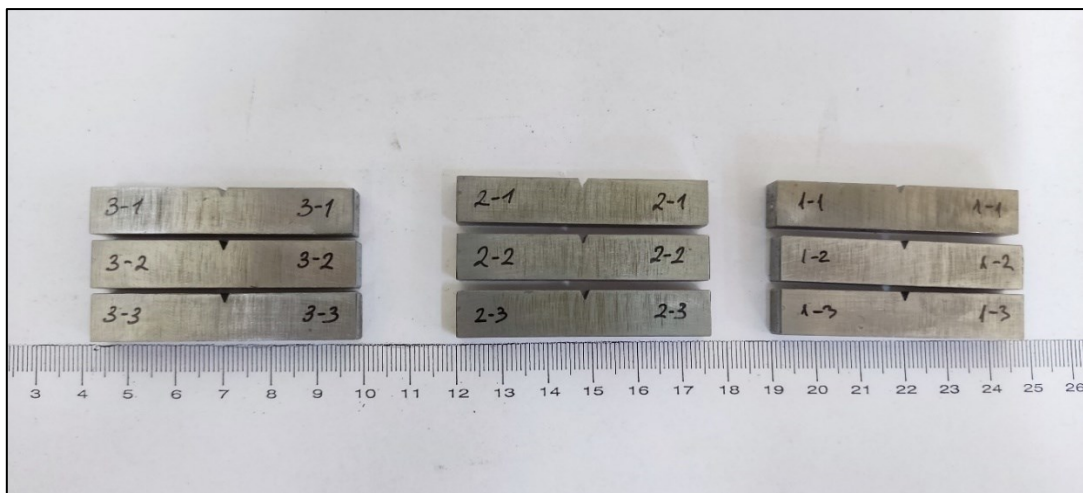
Slika 49. Charpy-jeve epruvete sa V zarezom
