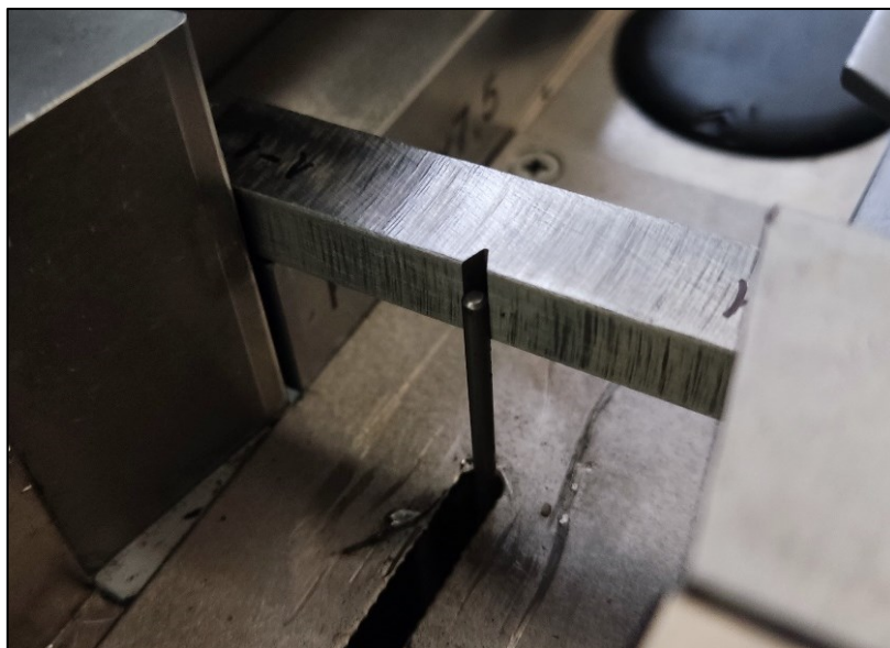
Slika 50. Charpy-jeva epruveta u horizontalnim držačima
