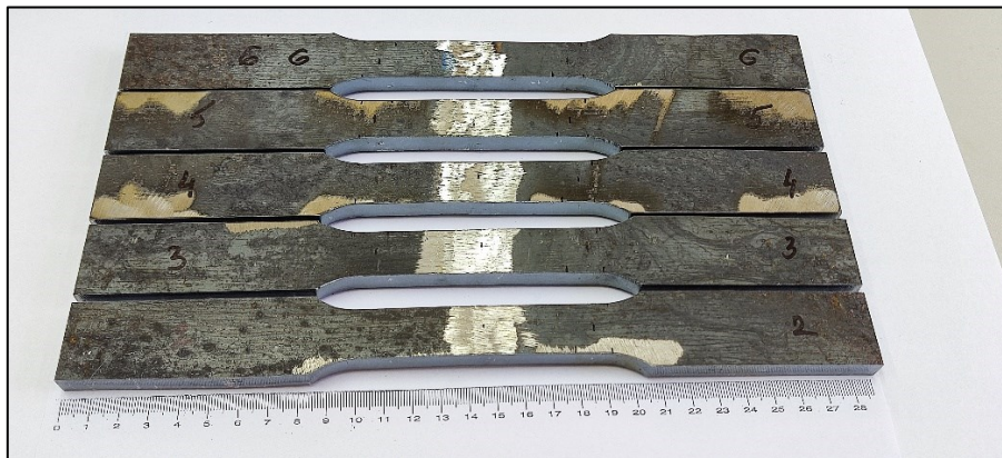
Slika 41. Epruvete za statički vlačni test
