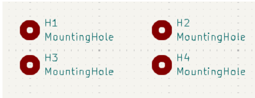
Slika 35: Rupe za montažu PCB pločice
