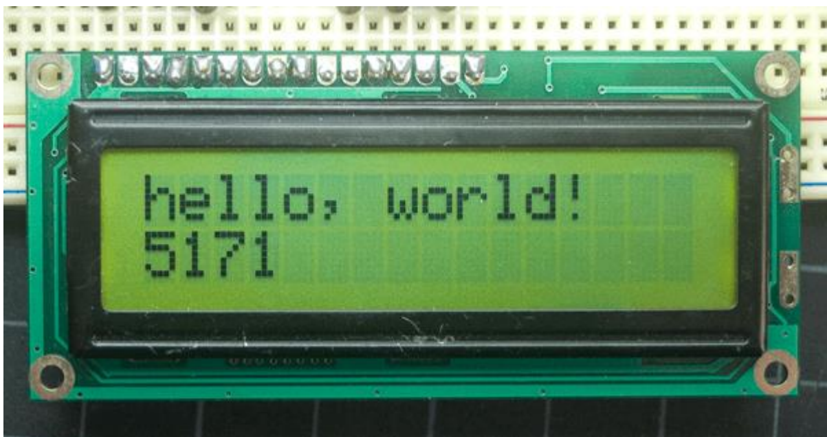
Slika 56: LCD displej 16x2
