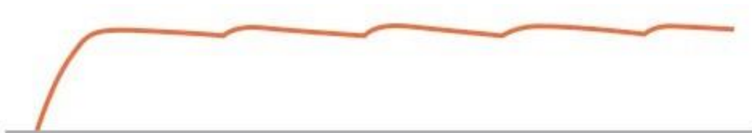
Slika 13 Prikaz napona sa kondenzatorom
