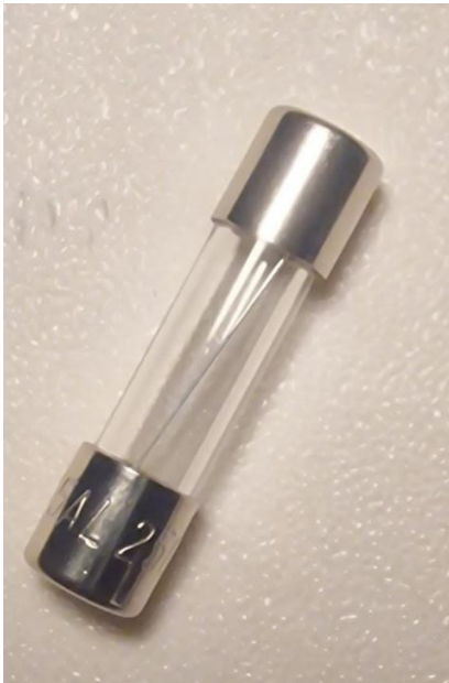
Slika 9 Prikaz staklenog osigurača
