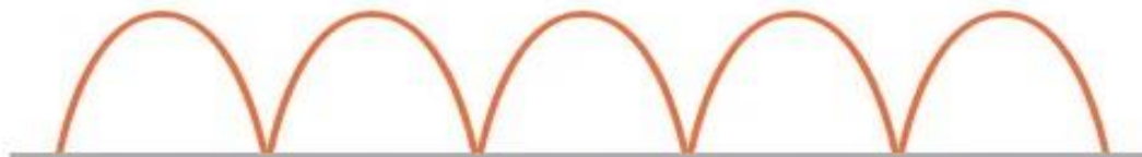
Slika 12 Prikaz napona bez kondenzatora
