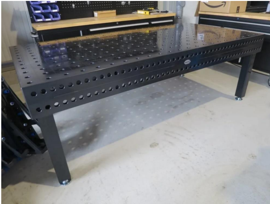
Slika 7. Metalni stol za implementaciju MIG zavarivanja
